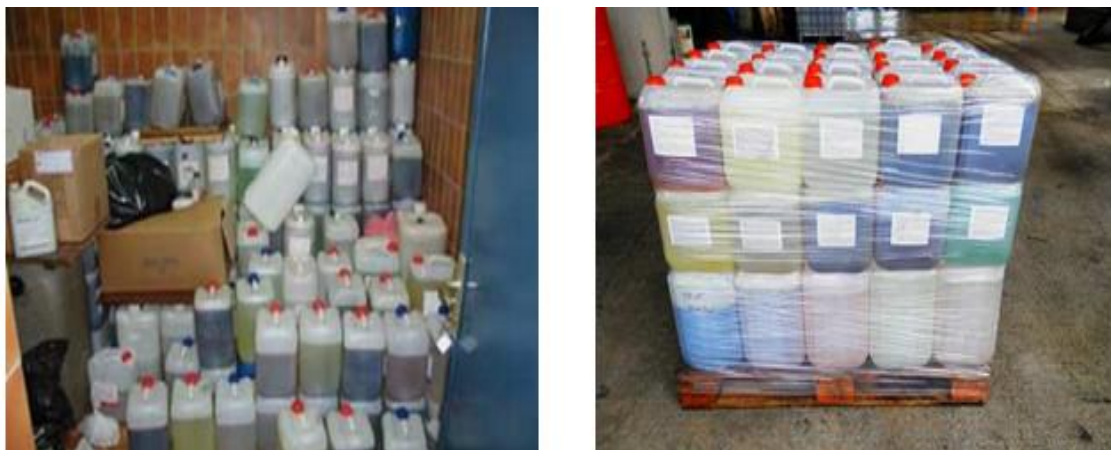
Slika 8. Skladištenje otpada nepodudarnih kemijskih svojstava [21]
