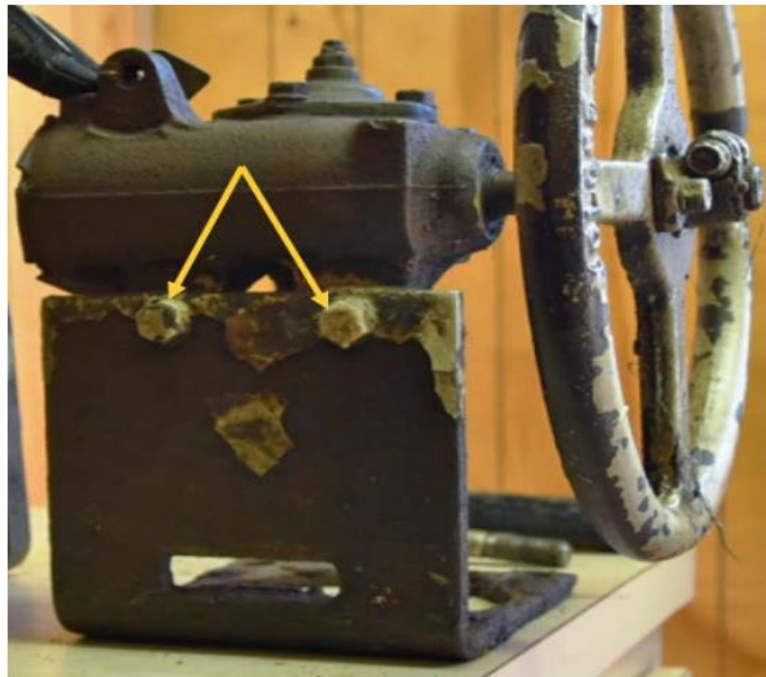
Slika 11. Aktuator sa mjesta nesreće. Žute strelice prikazuju koja je dva vijka trebalo ukloniti. [23]
