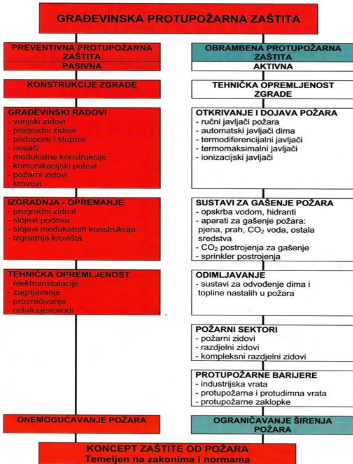
Sl. 1. Građevinska protupožarna zaštita [4]
