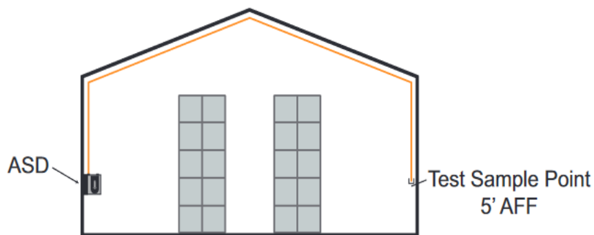
Sl. 32. Mjesto ispitivanja za skladišne prostore [9]
