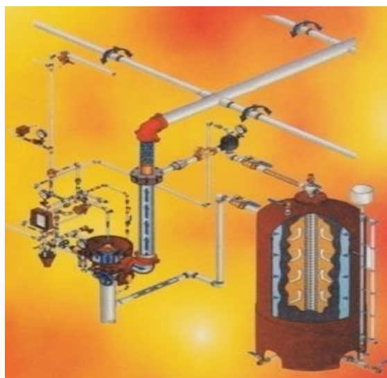
Sl. 5. Sprinkler sustav s pjenom [5]
