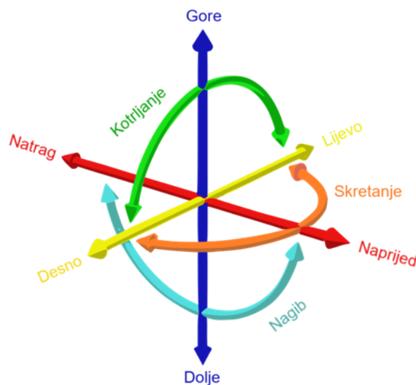
Slika 1. Prikaz 6 stupnjeva slobode [6]
