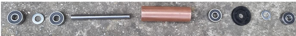
Slika 26. Sastavljanje pogonskog valjka.
