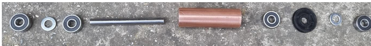
Slika 26. Sastavljanje pogonskog valjka.
