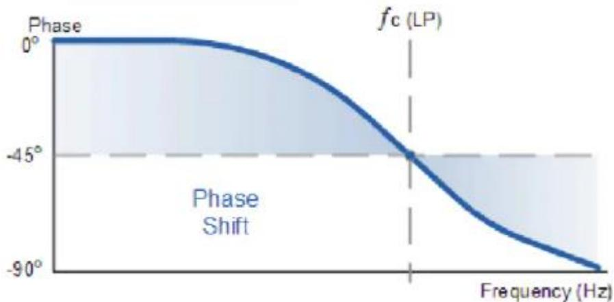
Slika 13. Fazno frekvencijska karakteristika RLC niskopropusnog filtra [3]
