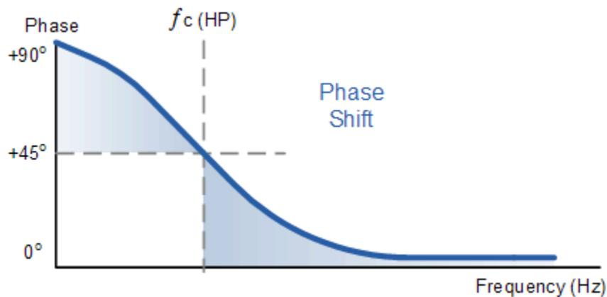
Slika 16. Fazno frekvencijska karakteristika RCL visokopropusnog filtra [4]
