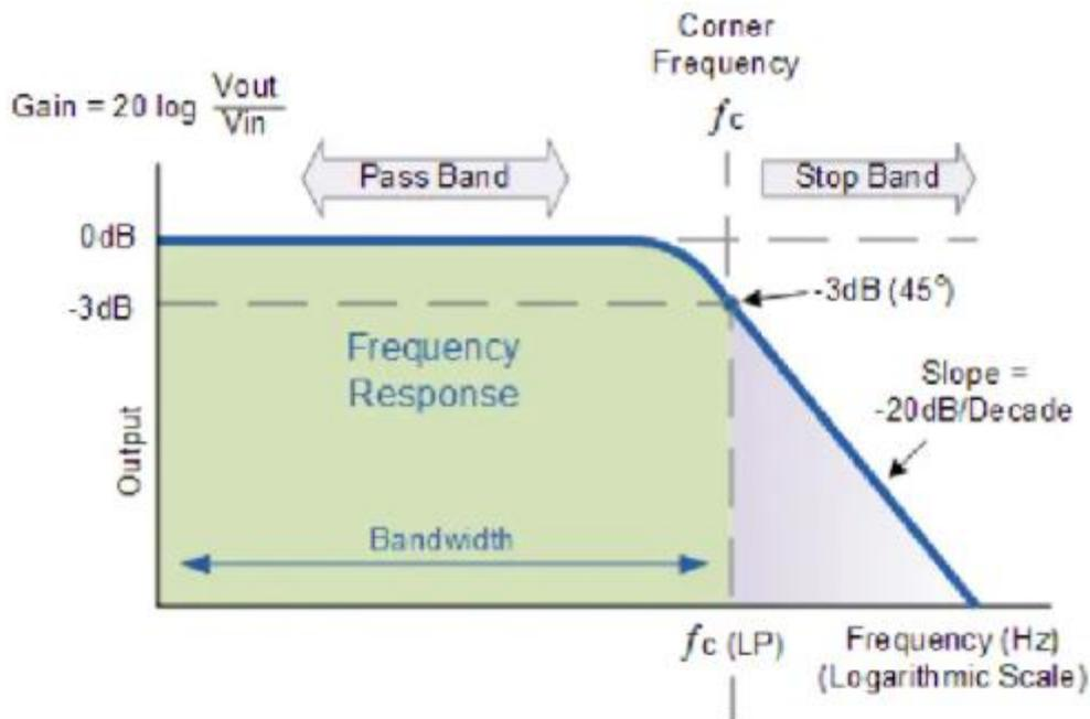
Slika 12. Amplitudno frekventijska karakteristika niskopropusnog RLC filtra [3]
