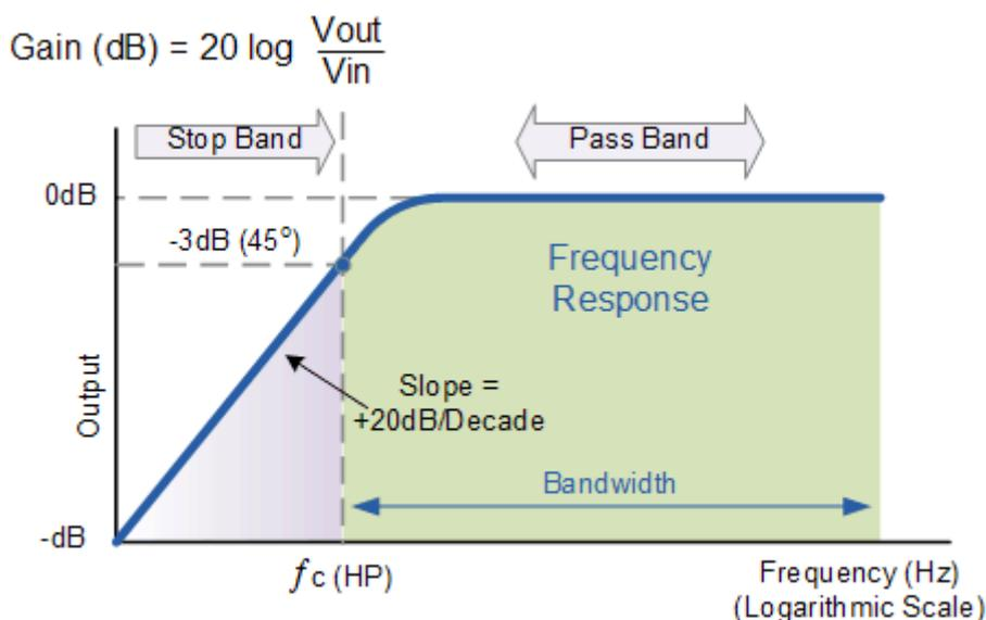
Slika 15. Amplitudno frekvencijska karakteristika visokopropusnog RCL filtra [4]
