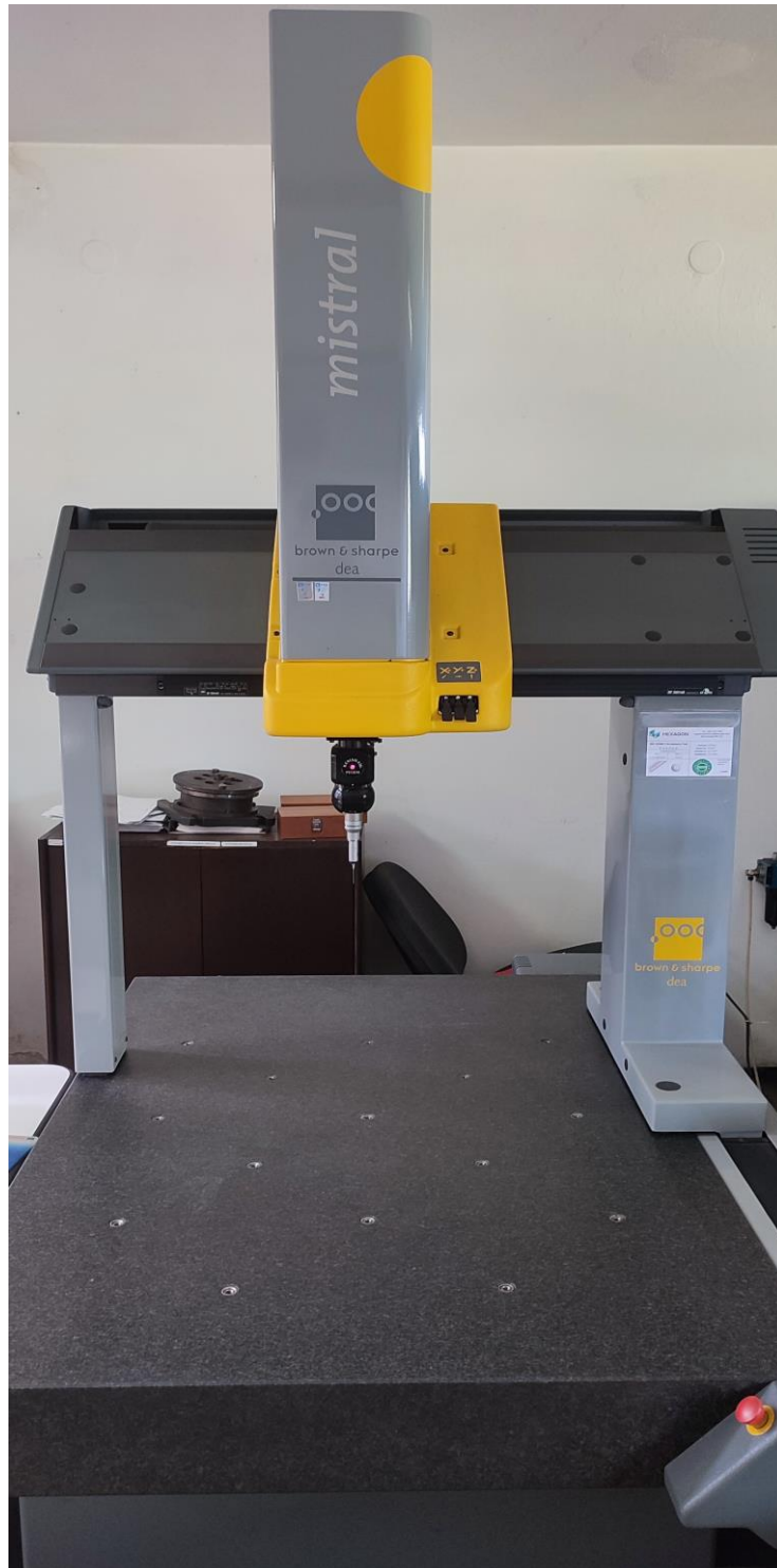
Slika 19 Predodžba mjernog uređaj Dea Mistral. Izvorno autor.
