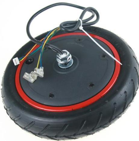
Slika 15 - Korišteni bezčetkični motor
