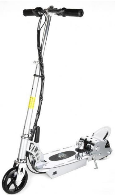
Slika 3 - Dječji električni romobil sa istosmjernim motorom.
