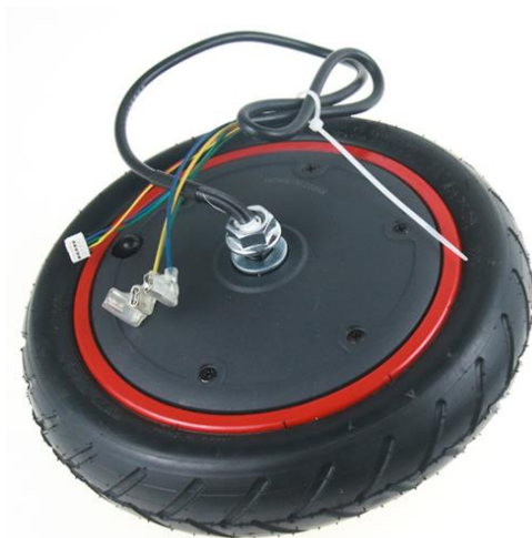
Slika 15 - Korišteni bezčetkični motor
