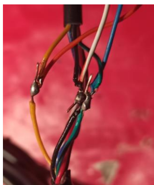
Slika 20 - Presretanje komunikacije tj. postavljanje sonde
