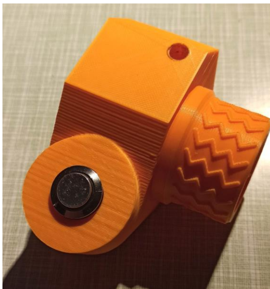
Slika 12 - Ručka akceleratora izrađena 3D ispisom
