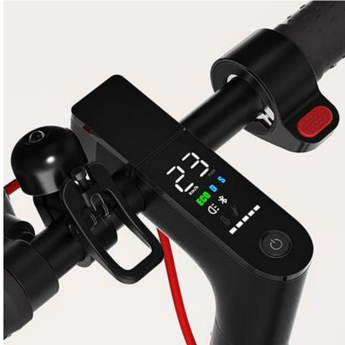
Slika 9 - Upravljačka ploča romobila Xiaomi M365 Pro
