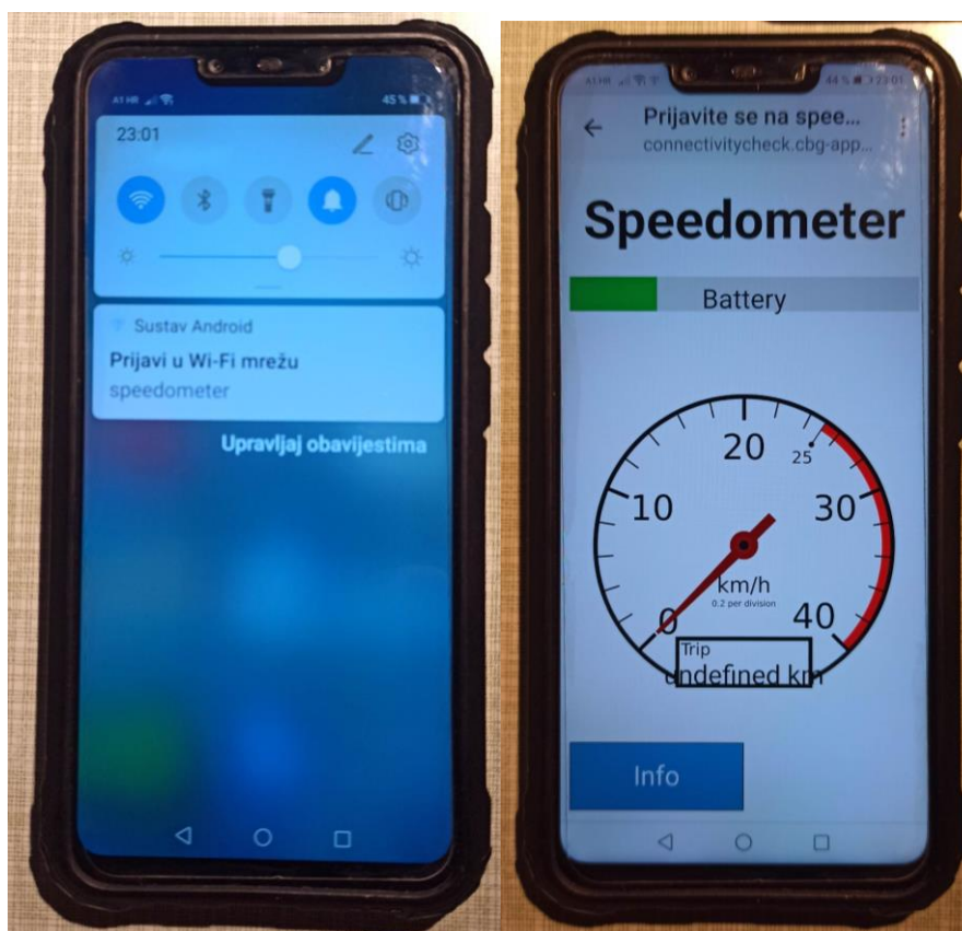
Slika 13 - Notifikacija kaptivnog portala koja otvara web stranicu brzinometra
