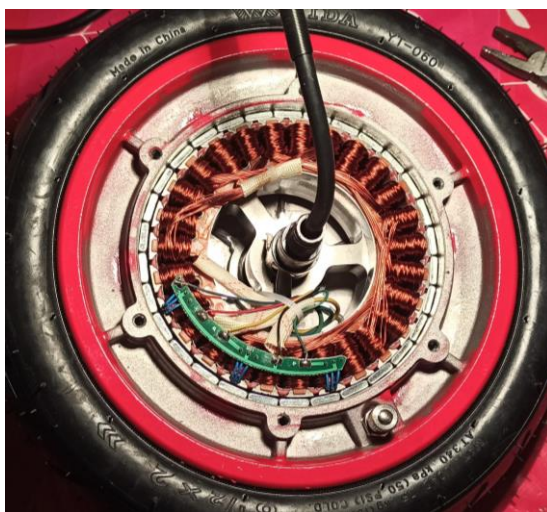
Slika 16- Unutrašnjost BLDC motora sa vidljivim magnetima rotora i namotom armature
