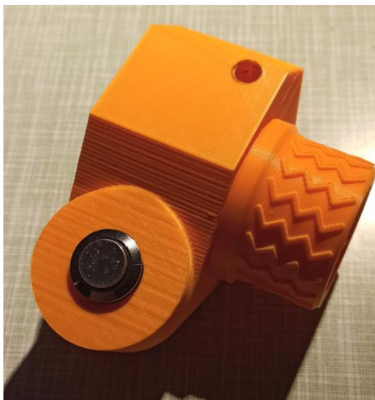
Slika 12 - Ručka akceleratora izrađena 3D ispisom
