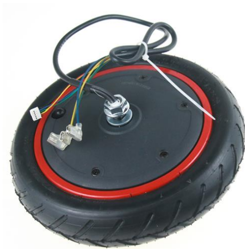
Slika 15 - Korišteni bezčetkični motor
