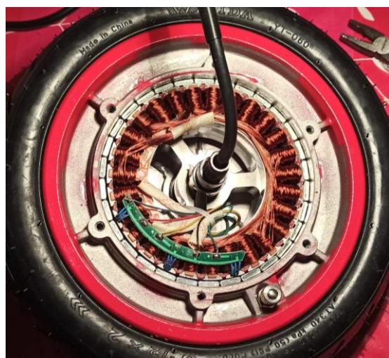
*Slika 16- Unutrašnost BLDC motora sa vidljivim magnetima rotora i namotom armature*
