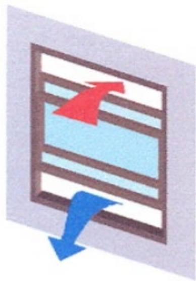
Slika 2. Efikasan otvor za prirodnu ventilaciju [1]
