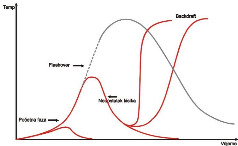
Slika 6. Razvoj požara u neventiliranom prostoru [8]
