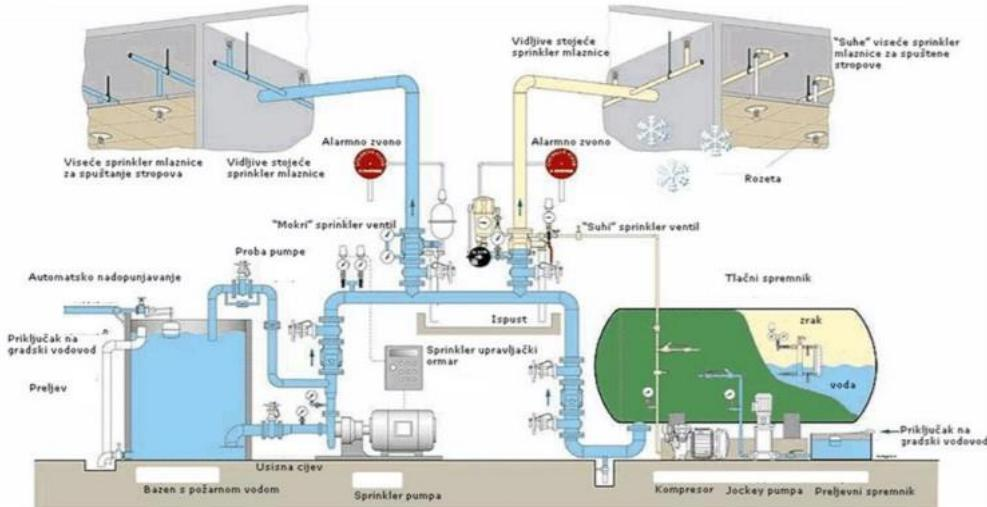
Slika 14. Shema kombiniranog (mokrog i suhog) stabilnog sustava za gašenje požara s automatskim radom tipa sprinkler [14]
