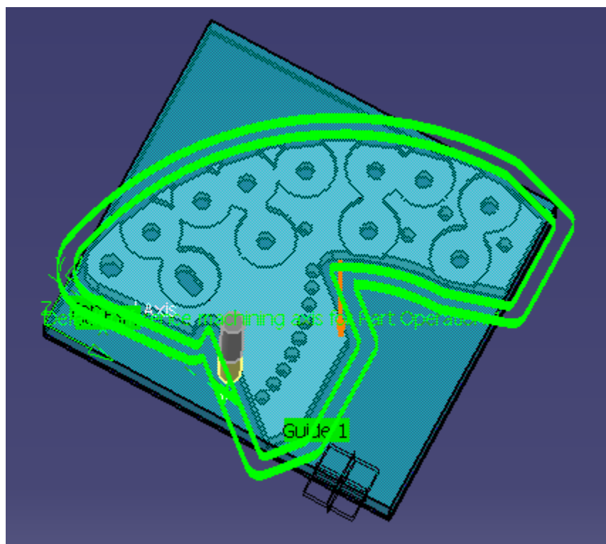
Slika 26. Simulacija putanje alata 3.
