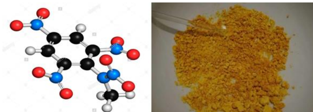
Sl. 16. Izgled i struktura tetrila [14]
