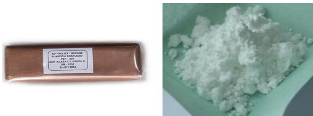
Sl. 18. Pentrit kao gotov eksploziv i u praškastom stanju [14]
