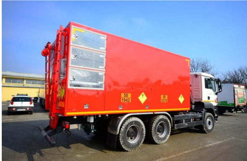
Sl. 9. Pokretna radionica za proizvodnju eksploziva „MEMU“ [8]
