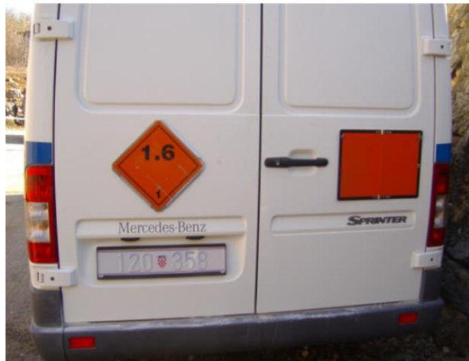
Sl. 12. Označavanje vozila za prijevoz opasnih tvari osnovnom i dopunskom pločom [6]
