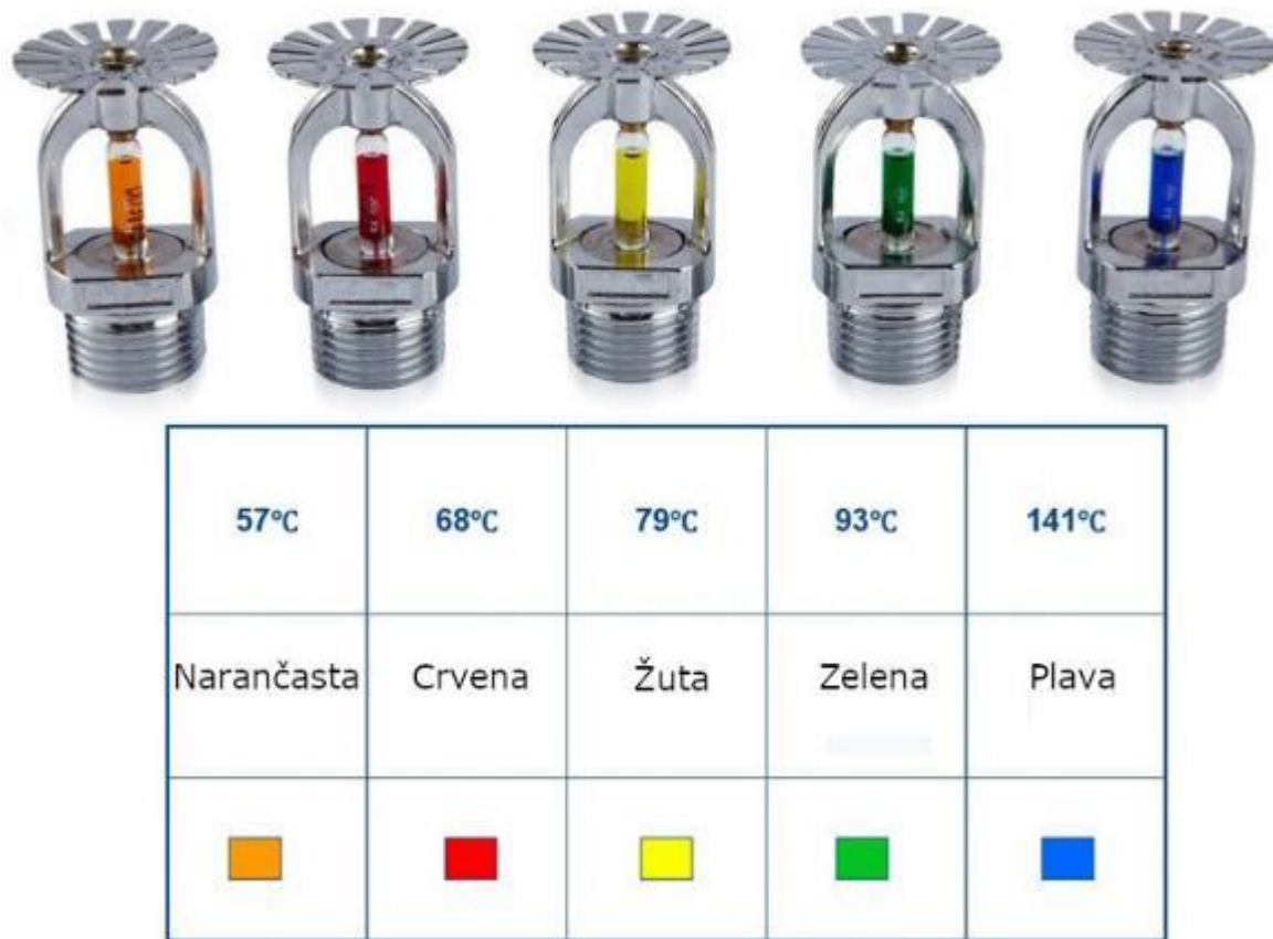
Slika 15. Ampule za mlaznice sprinkler sustava i s nazivnom temperaturom na kojoj prsnu [19]
