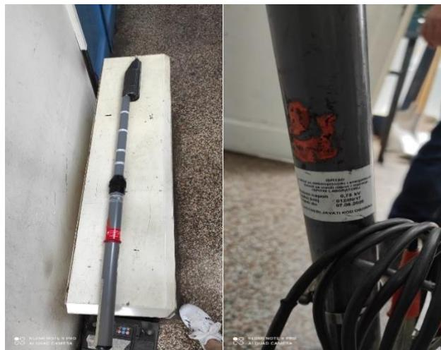
Slika 23. i 24. Detektor napona 6 – 690 V [9]
