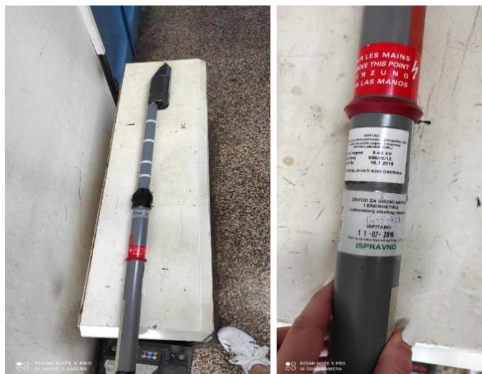
Slika 21. i 22. Detektor napona 20 kV [9]
