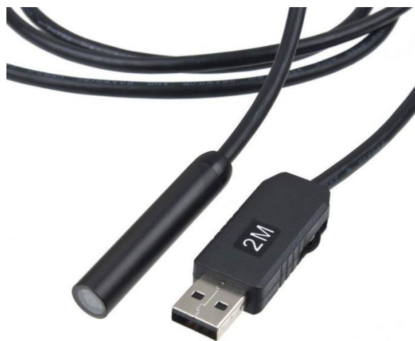
Slika 1. Mini USB kamera [ 1 ]
