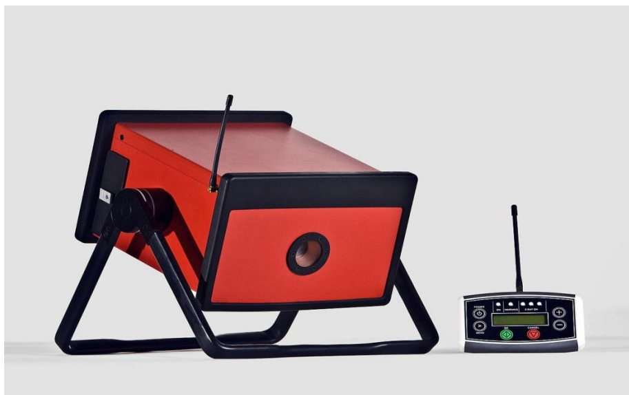
Slika 12. Prenosivi baterijski uređaj za stvaranje rendgenskih zraka [ 9 ]
