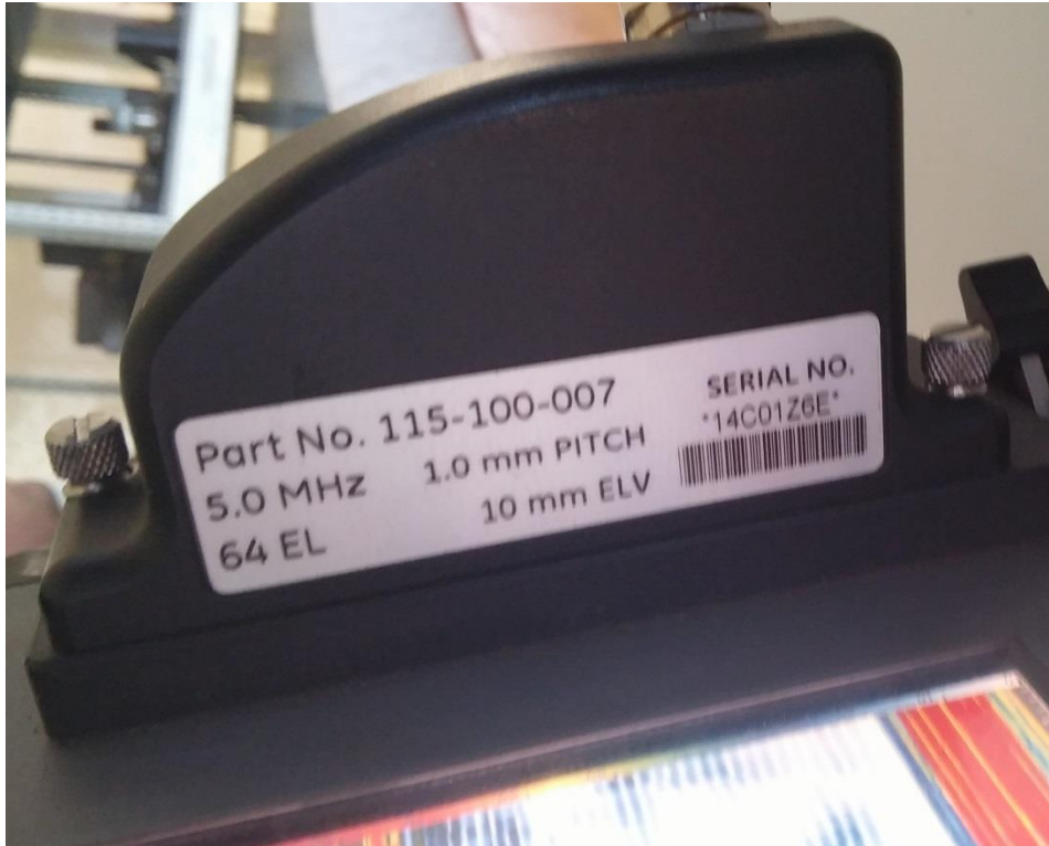
Slika 32. Sonda 5 MHz, 64 elementa
