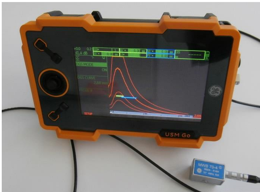
Slika 21. Uređaj za mjerenje ultrazvuka USM Go [ 17 ]
