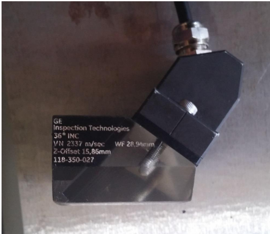
Slika 31. Sonda 2,25 MHz, 16 elemenata
