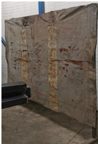
Slika 37. Zaštitna pregrada za zavarivanje
