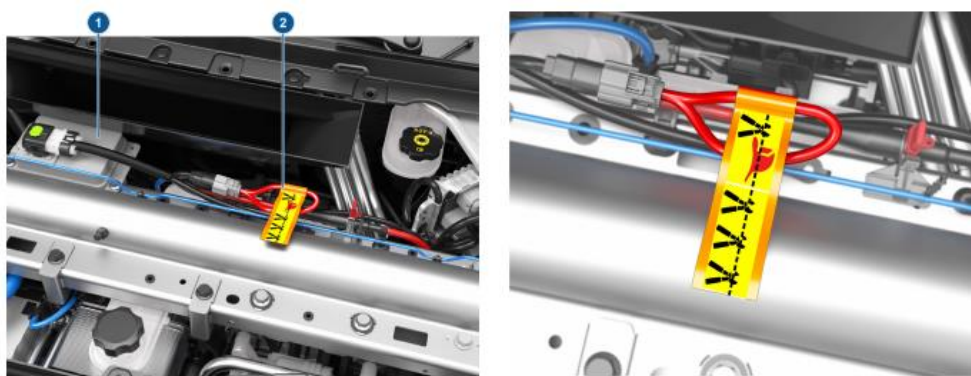
Slika 14. Mjesta isključenja 12V sustava: 1) konektor 12V baterije, 2) mjesto za prekid u nuždi [12]
