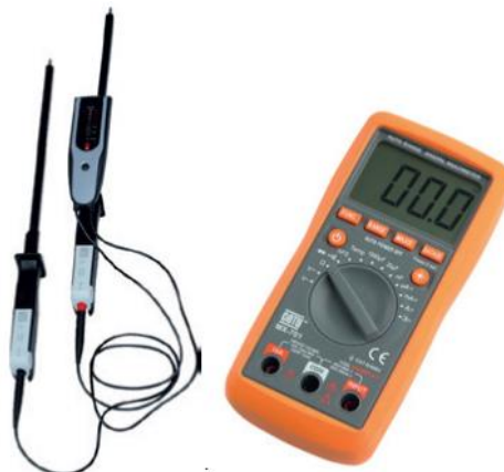
Slika 35. Uređaji za mjerenje visokog napona [17]
