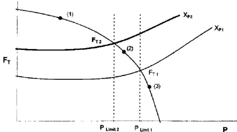
Slika 23. Situacija koje se mogu pojaviti prilikom korištenja metode 1 ili 2 tokom dizajniranja izmjenjivača topline, tj.(1)  $P \leq P_{Limit1}$ , (2)  $P_{Limit2} < P < P_{Limit1}$ , (3)  $P > P_{Limit1}$
