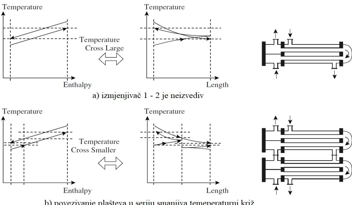
Slika 16. Izraženja vrijednost temperaturnog križa zahtijeva povezivanje plašteva izmjenjivača topline u seriju kako bi smanjio vrijednost temperaturnog križa u pojedinačnim izmjenjivačima topline [19]
