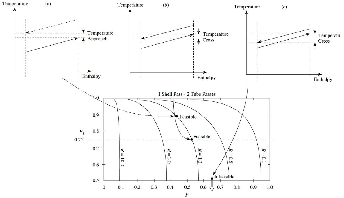
Slika 17. Prikaz  $F_T$  – grafa sa tri moguća odnosa izlaznih temperatura hladnog i toplog toka fluida, a) približavanje temperatura, b) temperaturno križanje-blago, c) izraženo temperaturno križanje [19]
