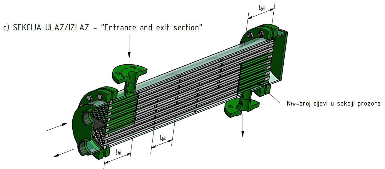
Slika 29. 3-D Prikaz izmjenjivača topline, podijeljen u 3 segmenta, prema Taborek-u: a) Sekcija središnjeg dijela ili unakrsnog toka ("Cross-flow section"), b) Sekcija prozora ("Window-section"), c) Sekcija ulaz/izlaz ("Entrance and exit section")
