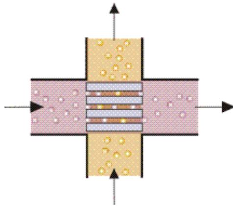
Slika 4. Shematski prikaz križnog tipa izmjenjivača topline [2]
