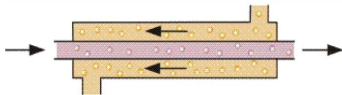
Slika 3. Shematski prikaz protusmjernog izmjenjivača topline [2]
