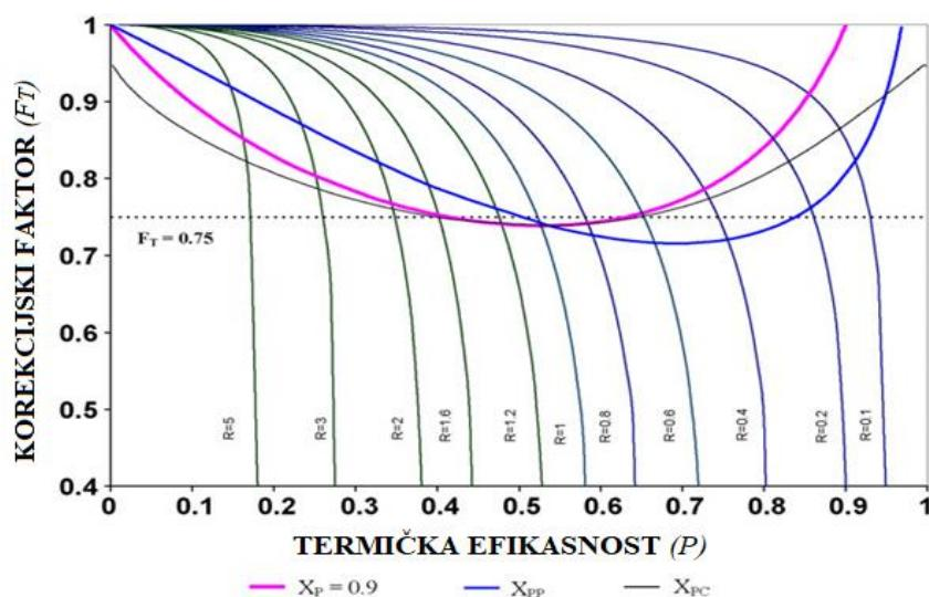
Slika 21. Usaporedba razlicitih metoda , za određivanje područja jednog ili za više izmjenjivača topline spojenih u seriju;  $F_T$  konstanta ( $F_{T\text{Min}} = 0.75$ ),  $X_P$  konstanta ( $X_P = 0.9$ ),  $X_{PP}$  pristup ( $F_T/P)_R$ ,  $X_{PC}$  pristup ( $F_T/X_P)_R$ ; [23]
