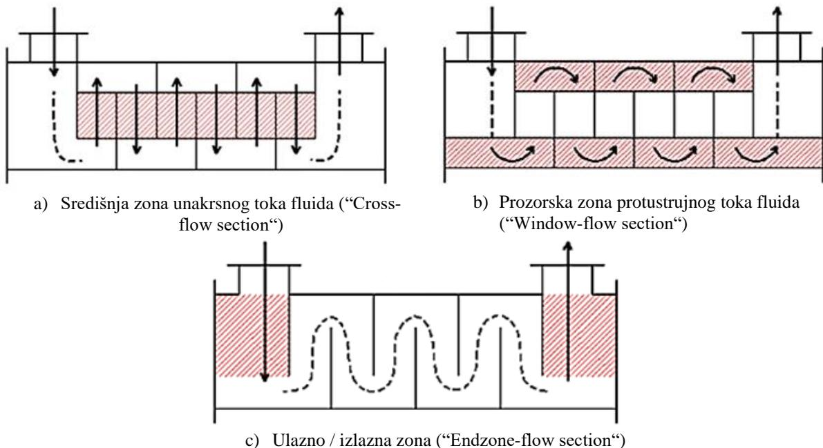
Slika 31. Shematski prikaz podjele izmjenjivača topline na tri zone, tj. područja pada pritiska na stani plašta:
