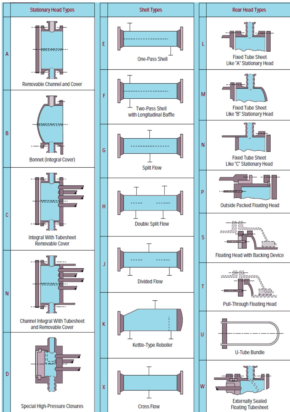
Slika 8. Oznake dijelova (prednji razdjelnik, plaš / ljusk i stražnji dio izmjenjivača topline) cjevnih izmjenjivača topline s plaštem prema TEMA Standardu [6]
