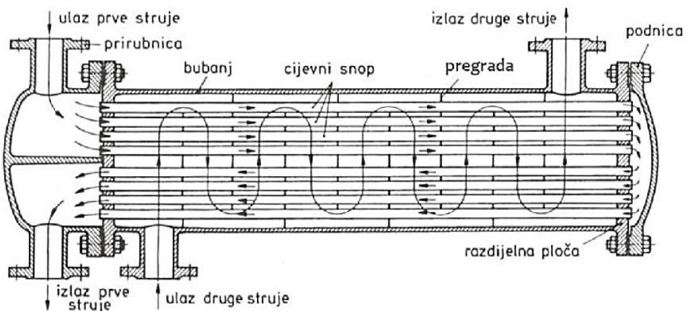
Slika 9. Shematski prikaz izmjenjivača topoline, tipa cijev u plaštu sa dva prolaza fluida kroz cijevi i jednim prolazom fluida kroz plašt
