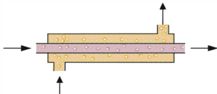
Slika 2. Shematski prikaz istosmjernog izmjenjivača topline [2]
