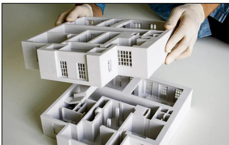
**Slika 29. Arhitektonski model izrađen aditivnom tehnologijom [32]**
