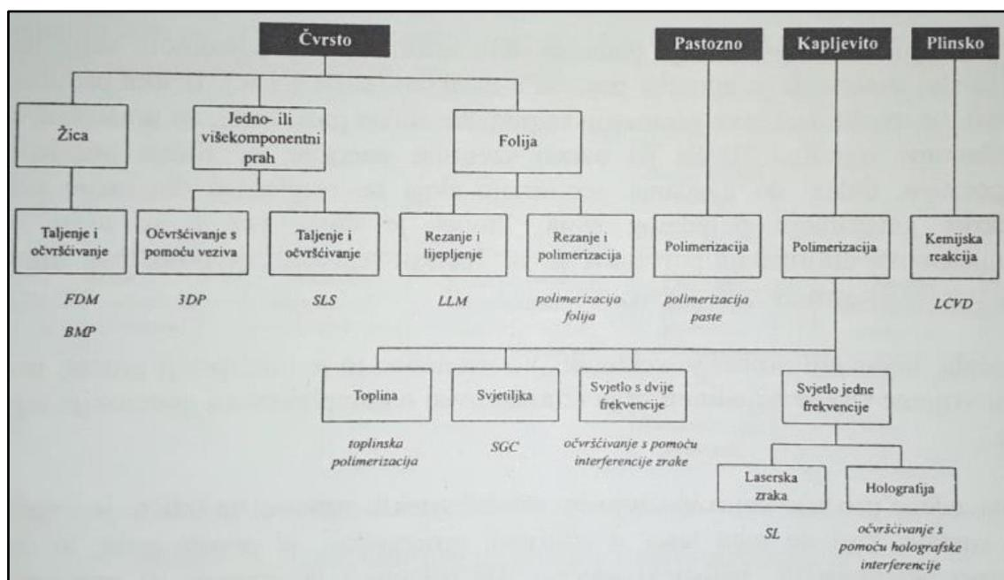
Slika 4. Klasifikacija postupaka proizvodnje aditivnom tehnologijom [1]
