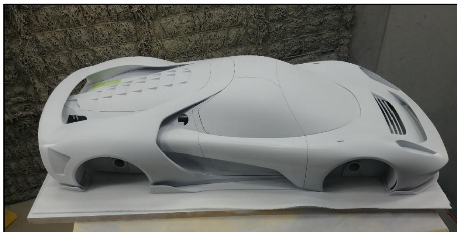
Slika 26. Konceptualni model automobila izrađen aditivnom tehnologijom [28]
