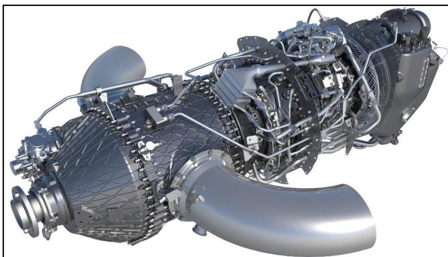
Slika 24. Zrakoplovni motor izrađen aditivnom tehnologijom [24]
