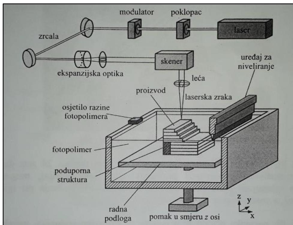
Slika 5. Princip rada osnovnog uređaja za stereolitografiju [5]
