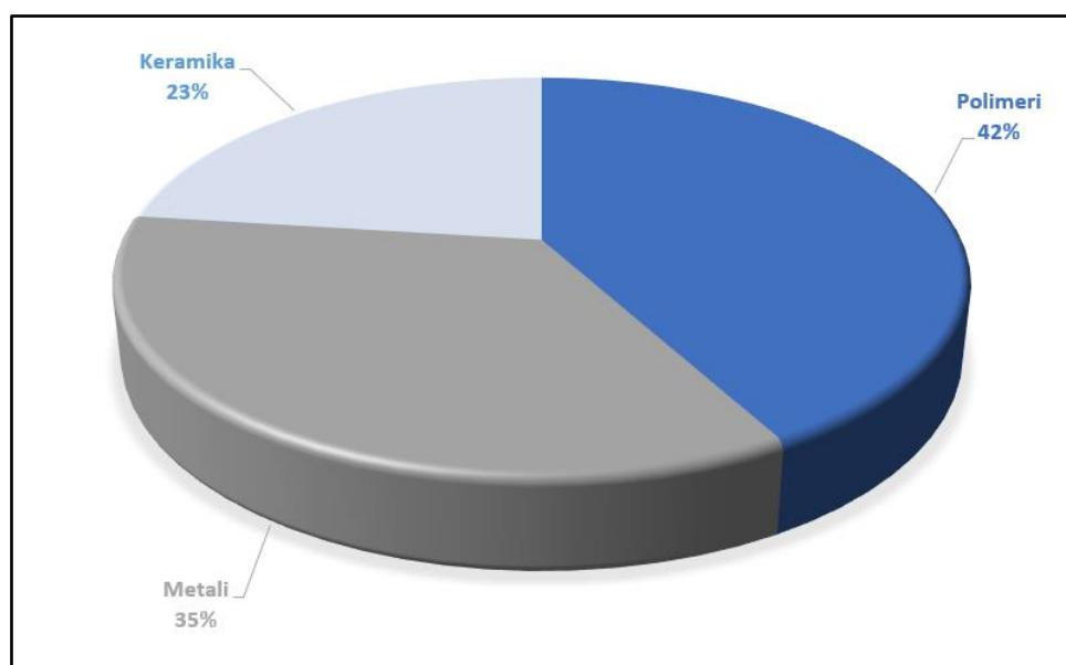
**Slika 23. Udeo materijala u aditivnoj proizvodnji [21]**
