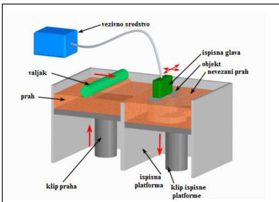
Slika 11. Princip rada osnovnog uređaja za 3D tiskanje [5]
