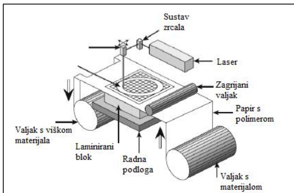
Slika 14. Princip rada osnovnog uređaja za laminiranje [5]
