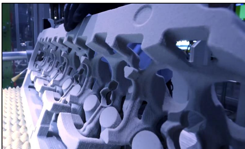
Slika 27. Pješčani kalup bloka motora bolida Formule 1 [29]
