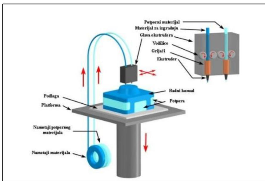
Slika 17. Princip rada osnovnog uređaja za taložno očvršćivanje [5]
