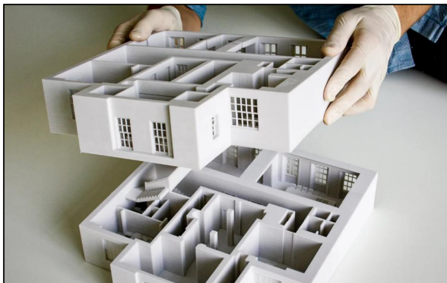
Slika 29. Arhitektonski model izrađen aditivnom tehnologijom [32]
