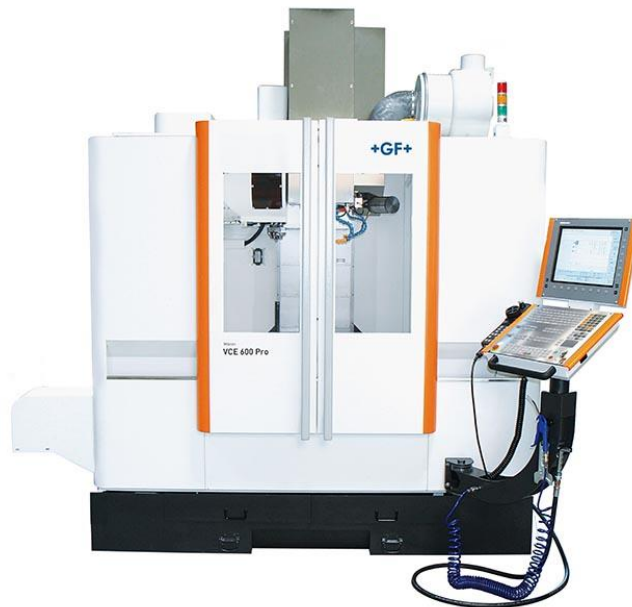
Slika 11. CNC GLODALICA Mikron VCE 600 pro
