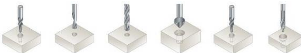
Slika 7. Obrada bušenja, zabašivanja, proširivanja ( razvrtavanja ) i upuštanja rupa [16]
