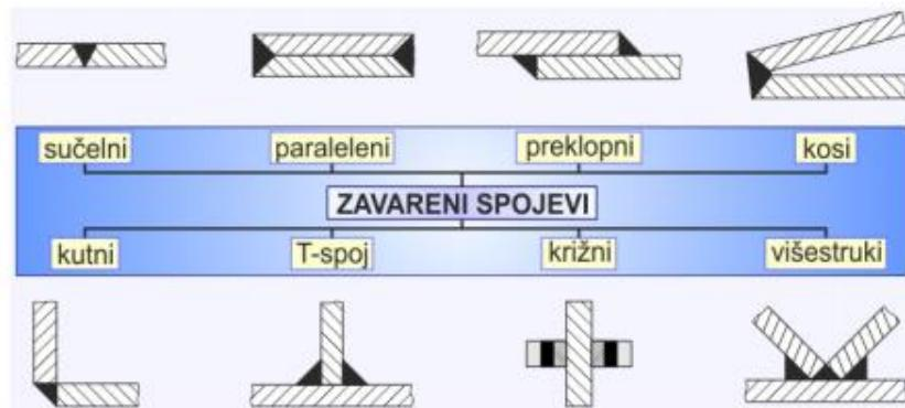
**Slika 31.** Neke od vrsti zavarenih spojeva [23]
