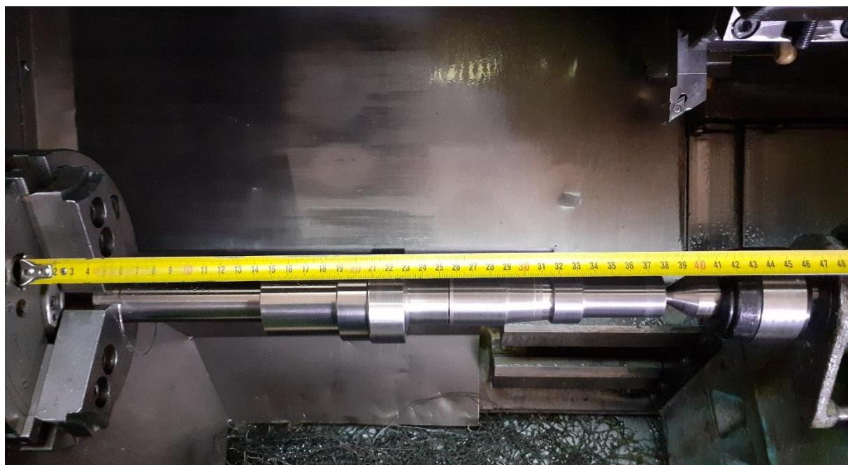
Slika 48. Grubo tokarenje u mekim čeljustima.
