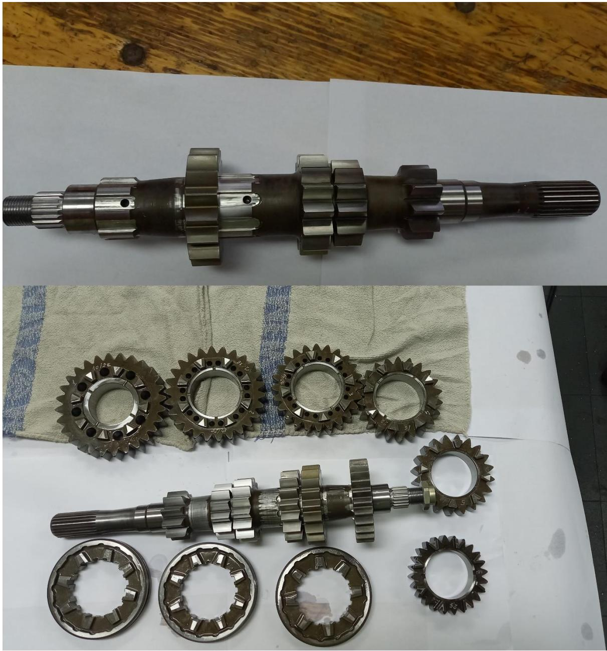
Slika 60. Montirani zupčanici na pogonskom vratilu.
