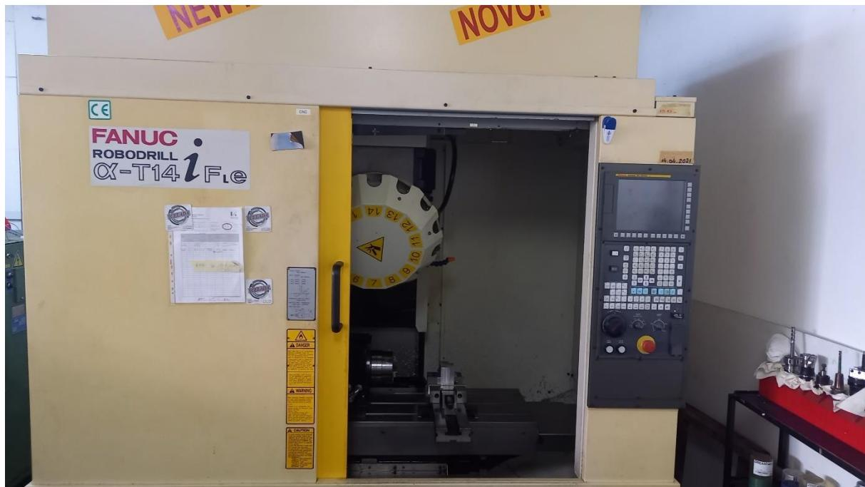
Slika 53. Vertikalni obradni centar.
