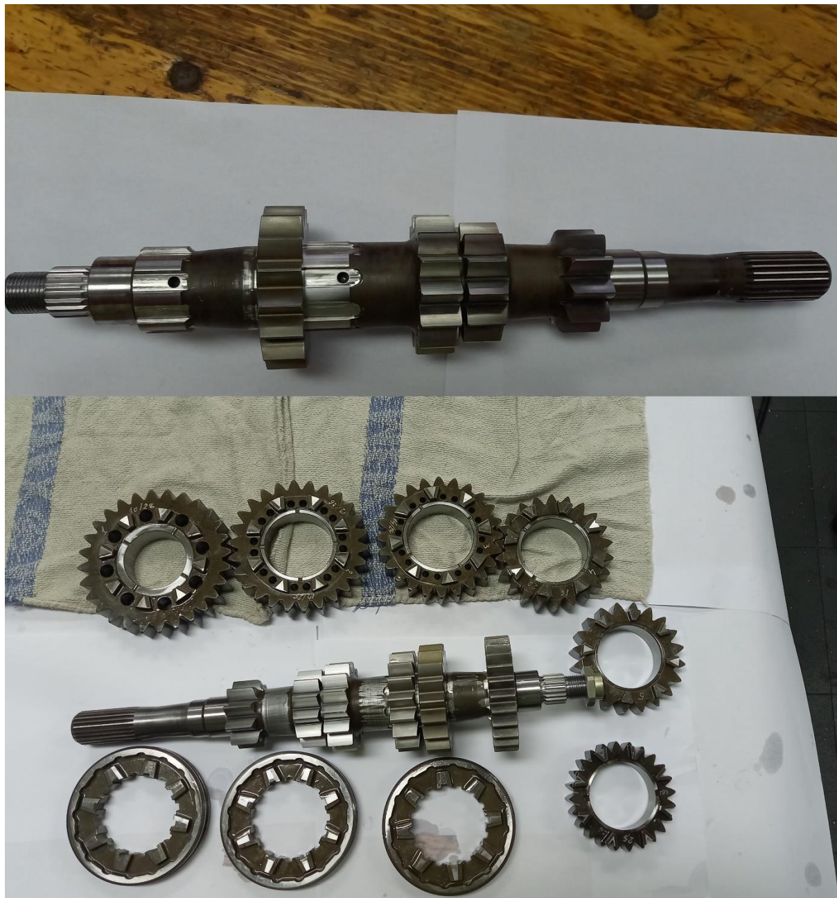
Slika 60. Montirani zupčanici na pogonskom vratilu.
