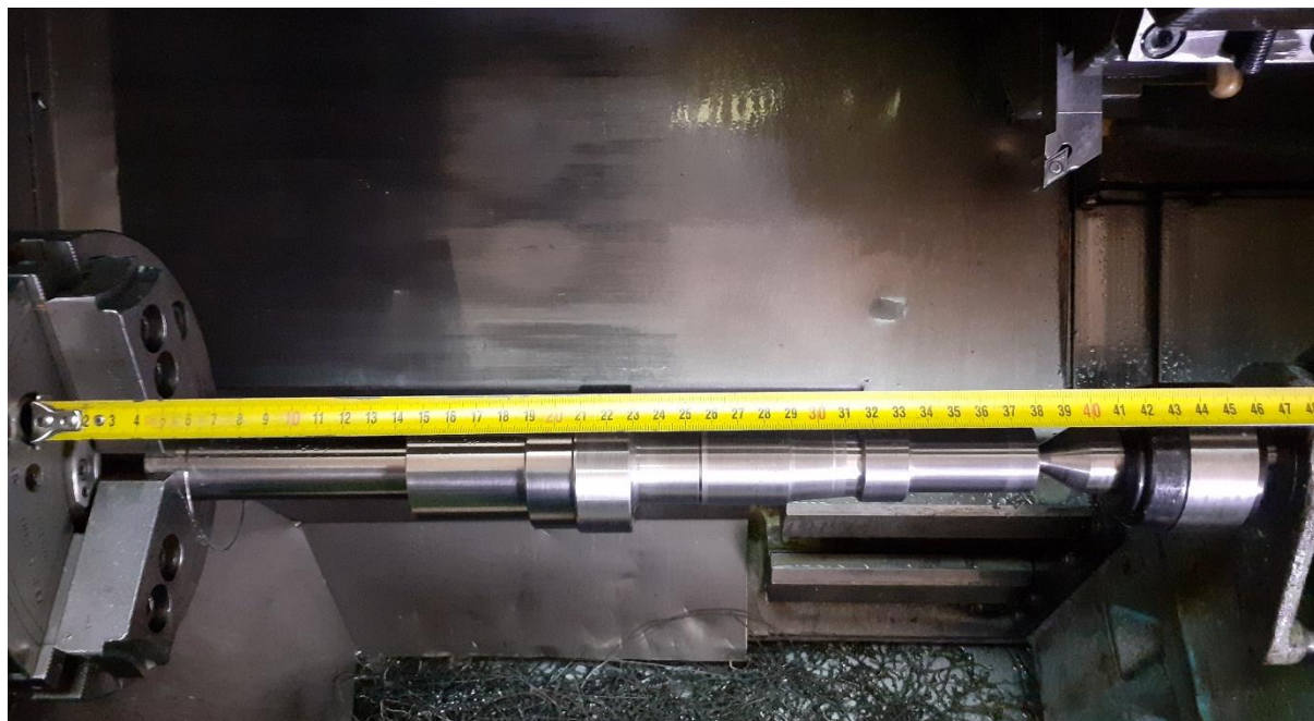
Slika 48. Grubo tokarenje u mekim čeljustima.
