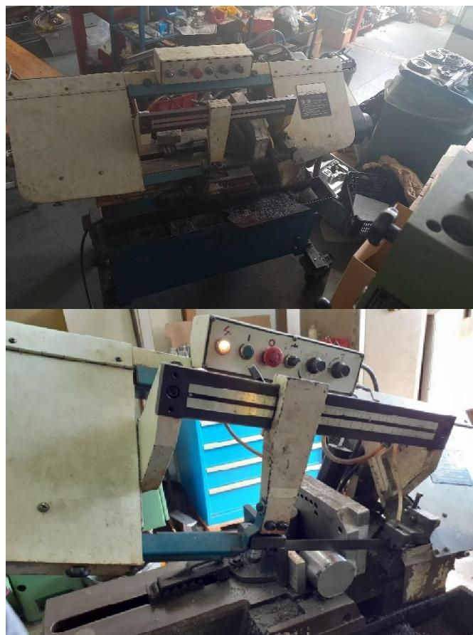
Slika 44. Tračna pila.
