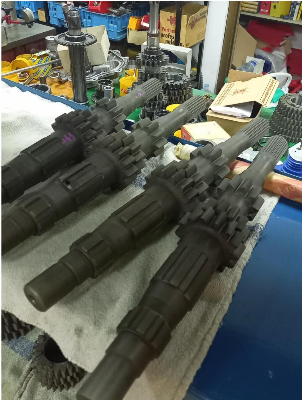
**Slika 57. Vratila nakon toplinske obrade.**
