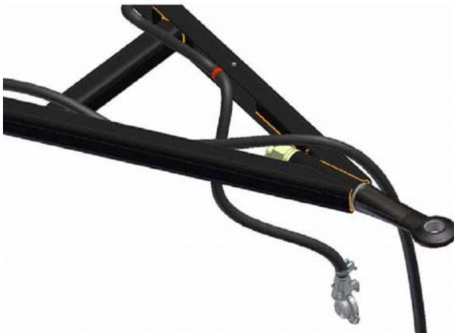
Slika 24. Rudo za zakretanje osovine kod prikolice [8]
