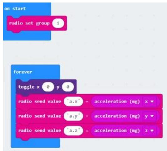
Slika 27. Kod udaljenog micro:Bit-a koji mjeri akcelerometrom
