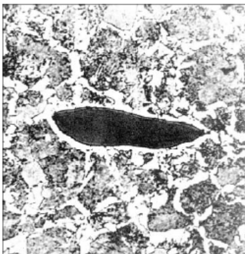
Slika 2.4.1. Sulfid MnS u čeliku sa 0,35%C [4]
