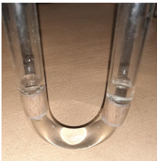
Slika 25. Klipovi zablokirani unutar U-cijevi
