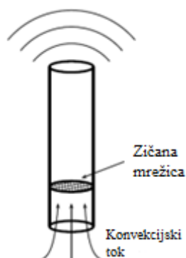
Slika 3. Shema Rijkeove cijevi [4]
