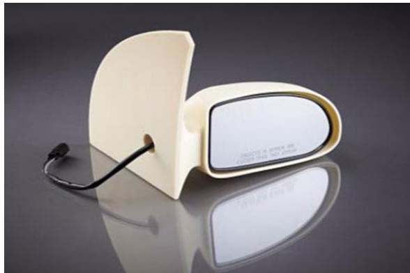
Slika 6. Model izrađen ASA materijalom
