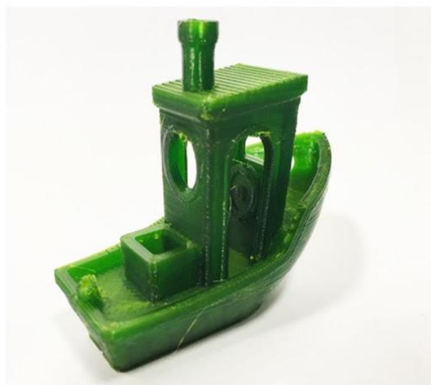
Slika 9. Model izrađen PETG materijalom [21]
