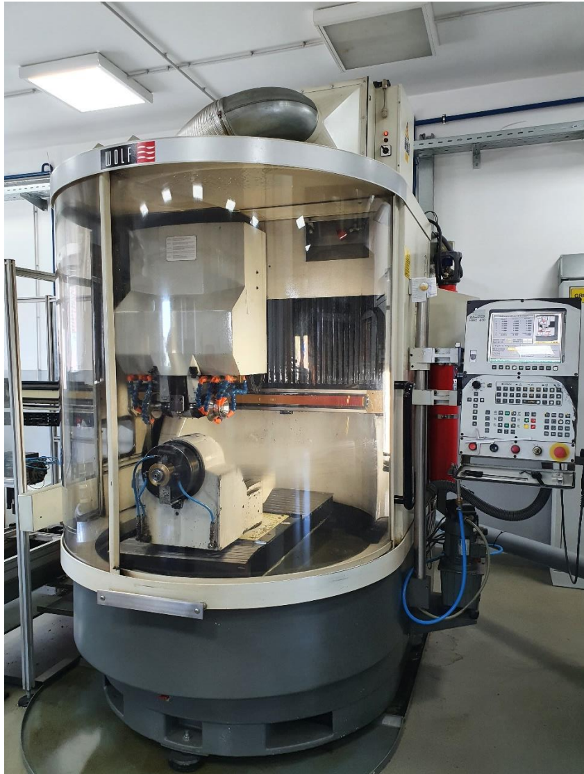
Slika 29. Pet osni CNC obradni centar Walter HMC 400
