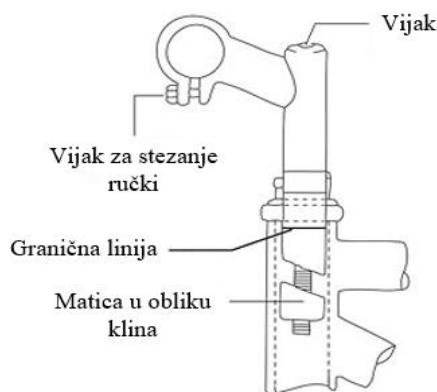
Slika 40 Montaža lule i vilice – presjek [14]
