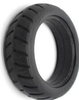
Slika 3 Puna guma za električni romobil [3]
