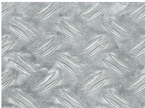
Slika 36 Uzorak rebraste aluminijske ploče korištene za gazište električnog romobila [13]
