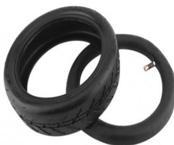
Slika 2 Pneumatska guma za električni romobil [2]
