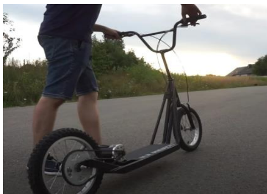
Slika 7 Električni romobil s nesklopivim upravljačem [7]
