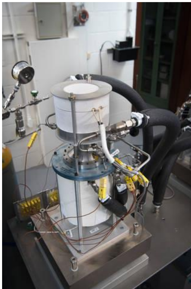
Slika 6. Stirlingov motor izrađen od strane NASA-e koji je radio 14 godina bez održavanja [51]
