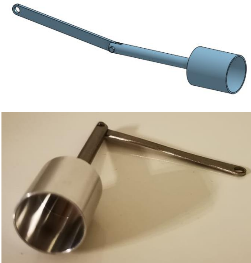
Slika 32. Potiskivač s klipnjačom u Onshape CAD programu i komponenta makete [Izvor: rad autora]
