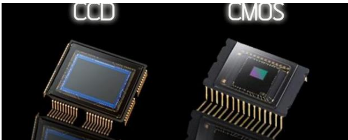
Slika 16. CCD i CMOS senzor
