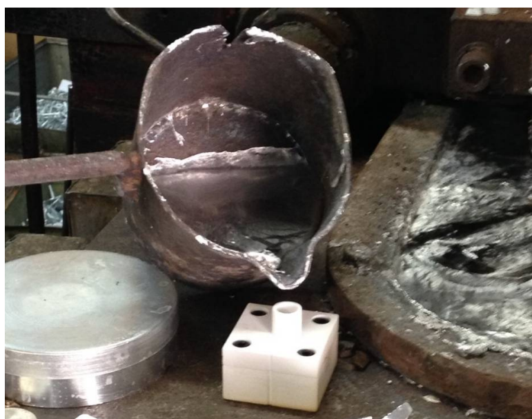
Slika 28. Ulivanje litine Zamak 2 ( ZnAl_4Cu_3 ) u kalup 1
