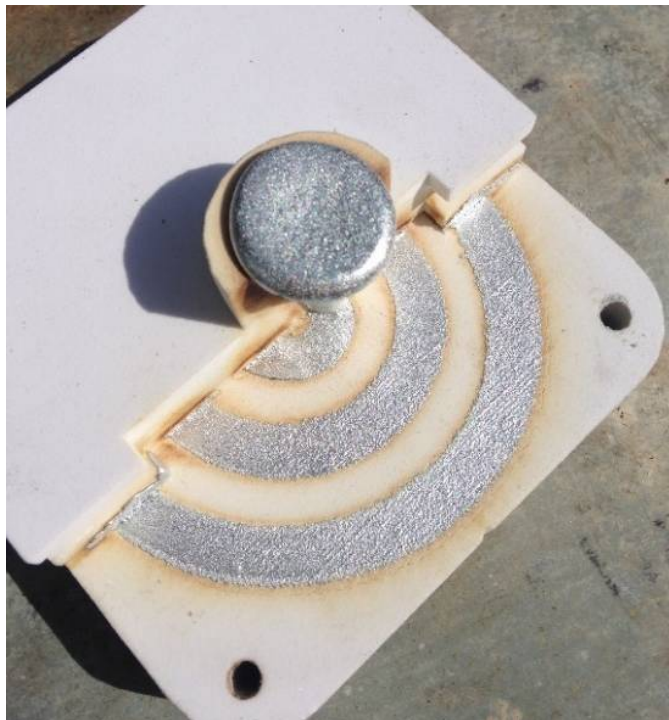
Slika 64. Micanje gornjeg lijevog dijela kalupa 2
