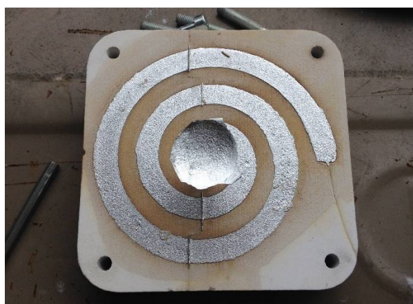
Slika 80. Odljevak nakon trećeg lijevanja u kalup 3
