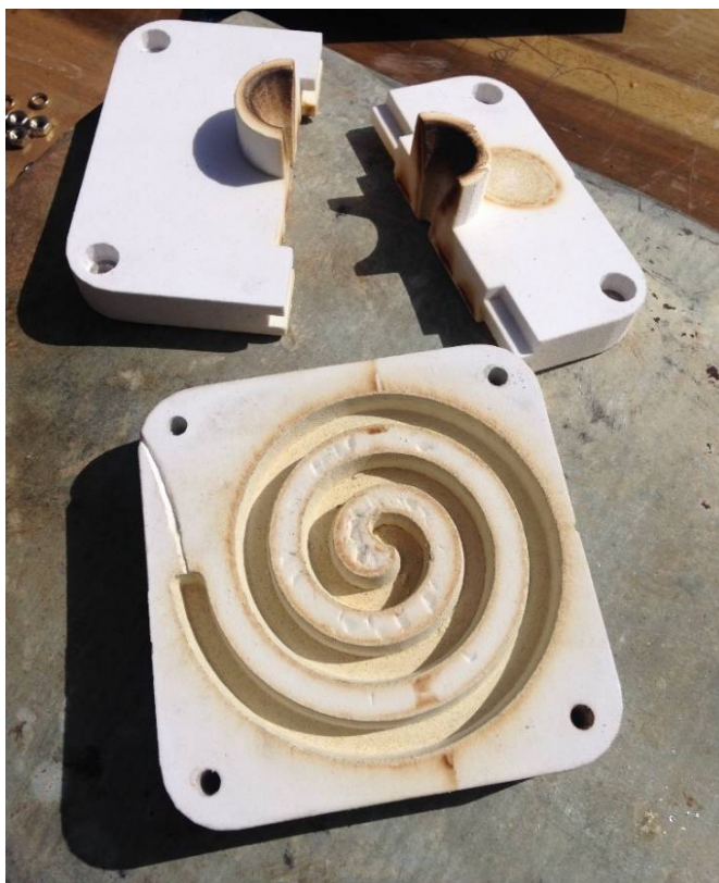
Slika 65. Otisci vađenja odljevka nakon drugoga lijevanja od pomoćnih alata
