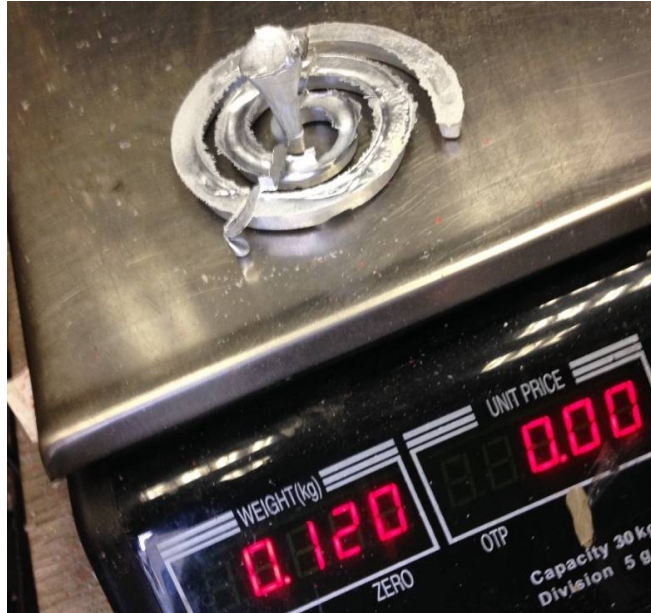
Slika 76. Masa odljevka nakon prvog lijevanja u kalup 3
