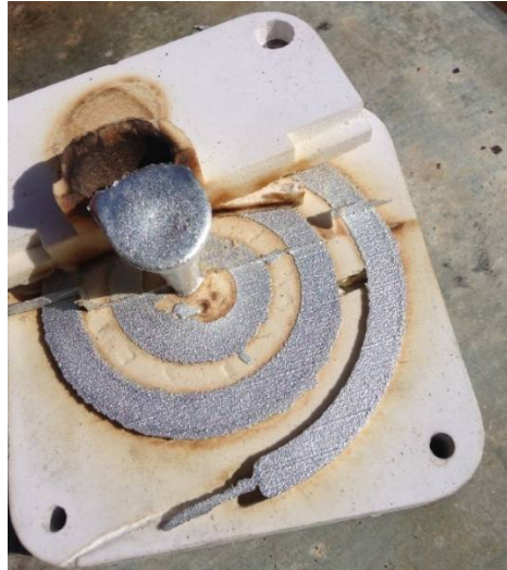
Slika 69. Pucanje Kalupa 2 prilikom vađenja odljevka
