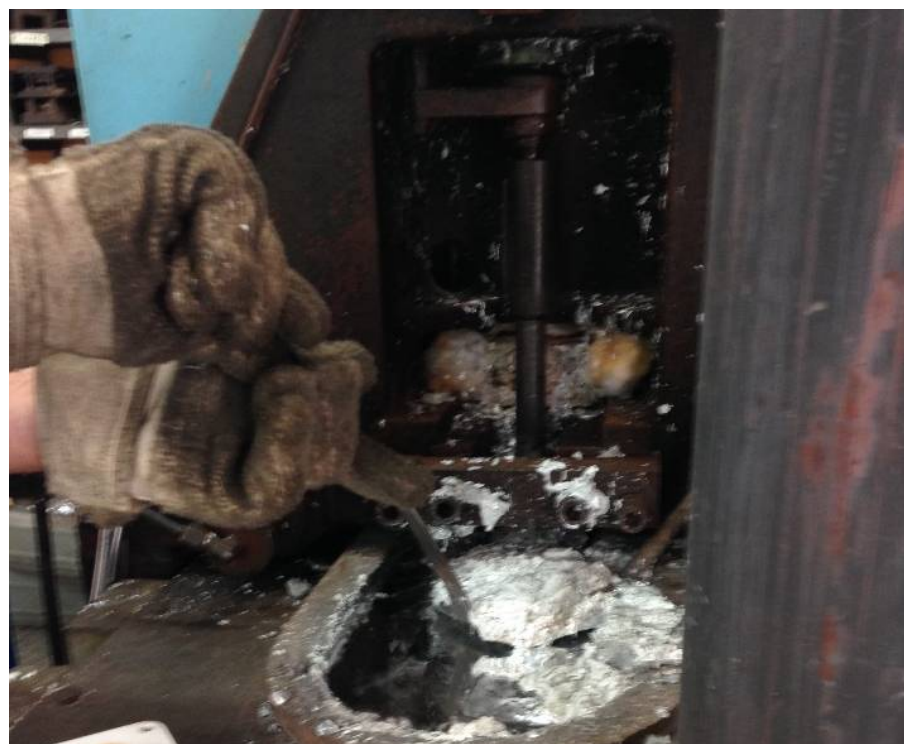
Slika 10. Odstranjivanje oslobođenih oksida sa površine taline
