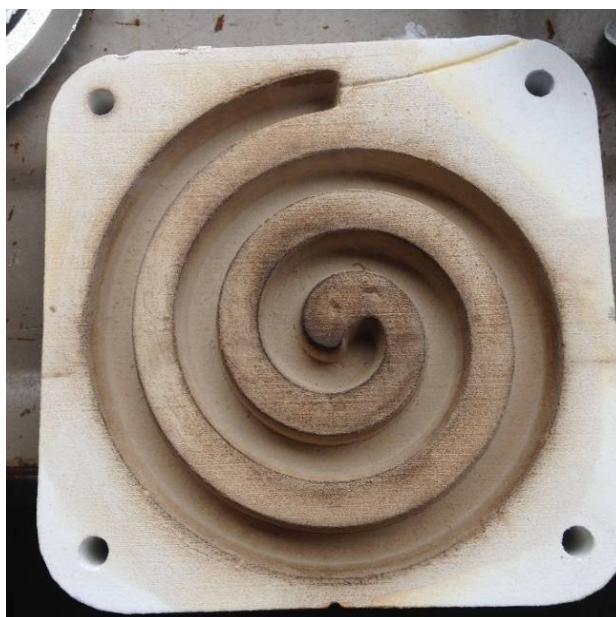
Slika 84. Kalup 3 nakon četvrtog lijevanja
