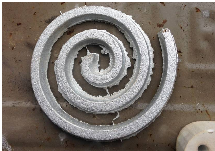
Slika 83. Odljevak nakon četvrtog lijevanja u kalup 3
