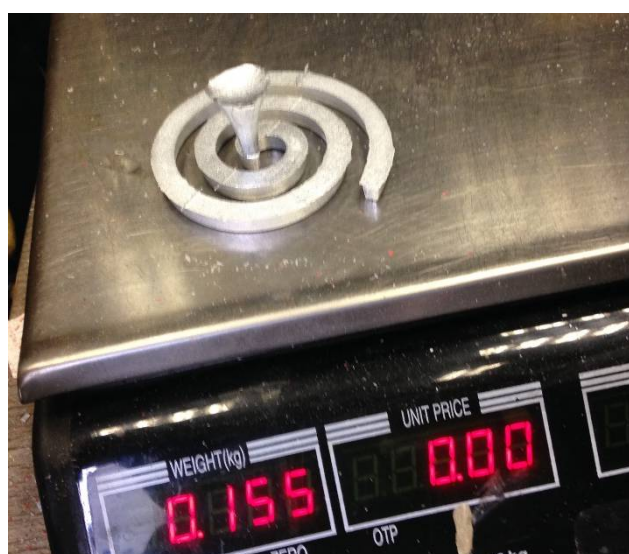
Slika 82. Masa odljevka nakon tećeg lijevanja u kalup 3
