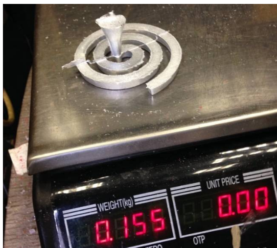
Slika 79. Masa odljevka nakon drugog lijevanja u kalup 3
