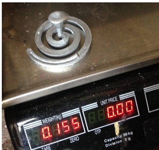
Slika 62. Masa odljevka nakon prvog lijevanja
