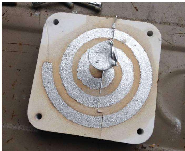
Slika 77. Odljevak nakon drugog lijevanja u kalup 3
