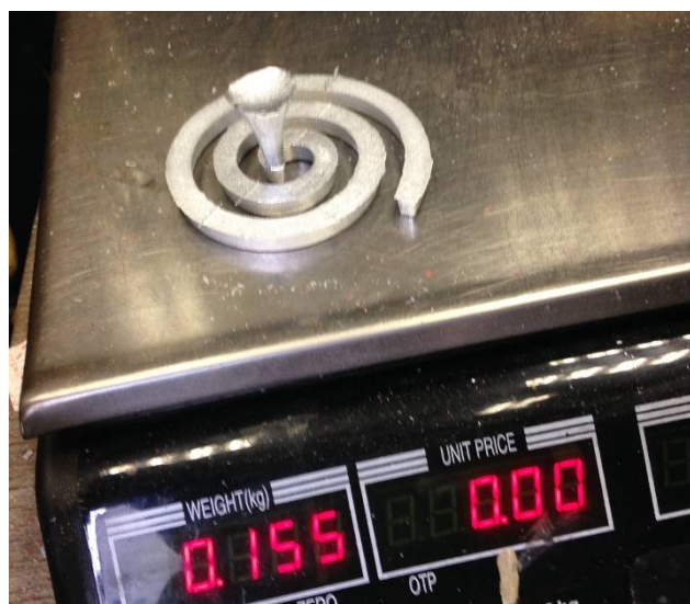
Slika 82. Masa odljevka nakon tećeg lijevanja u kalup 3
