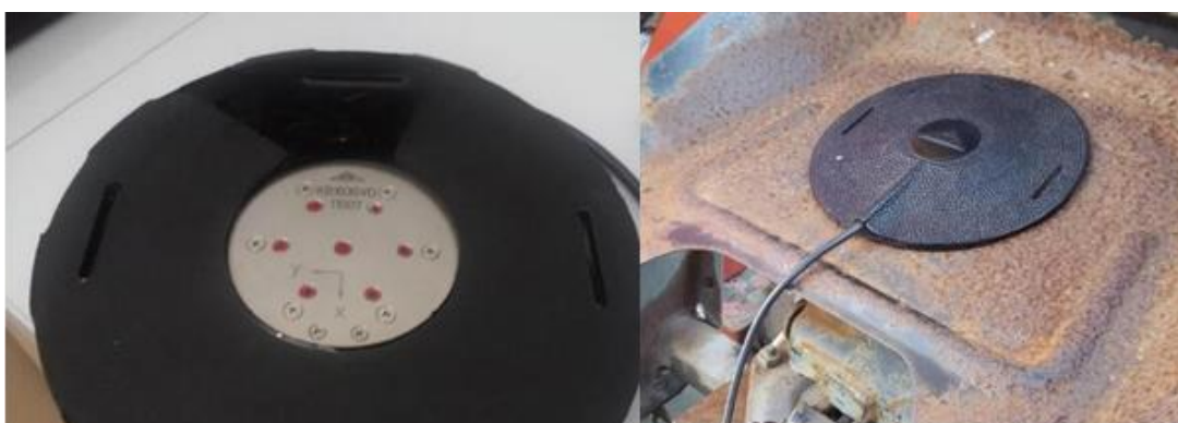
Slika 12. Prikaz akcelerometra koji mjeri u tri osi
