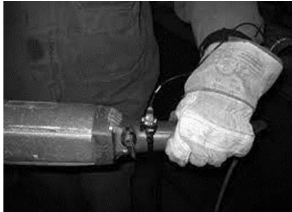
Slika 10. Prikaz mjerenja vibracija sustava ruka-šaka
