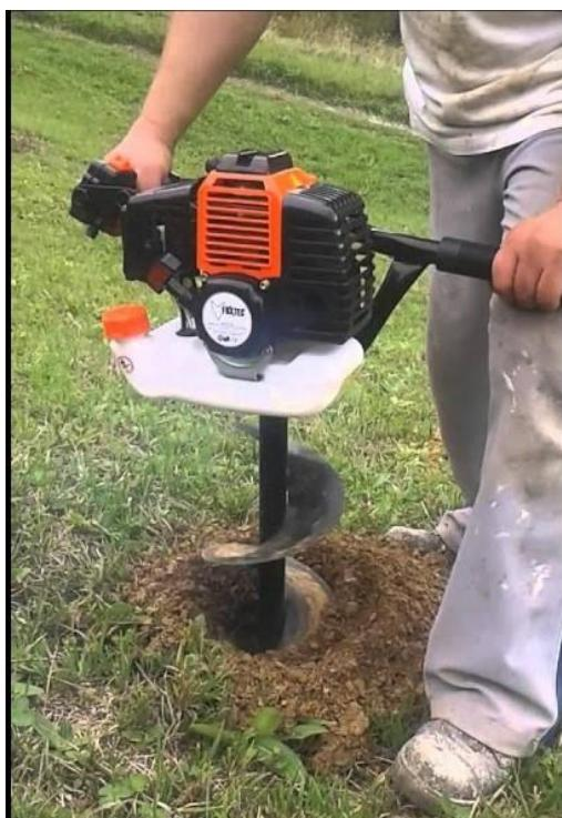
**Slika 8:** Bušenje rupa strojno
