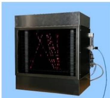
Slika 18. Komora na iskre
