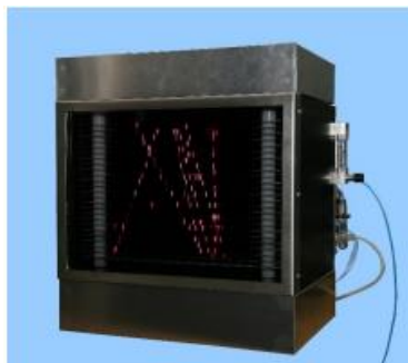
Slika 18. Komora na iskre
