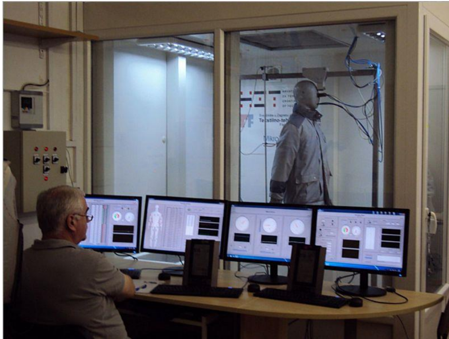
Slika 31: Termalni maneken s Tekstilno-tehnološkog fakulteta u Zagrebu
