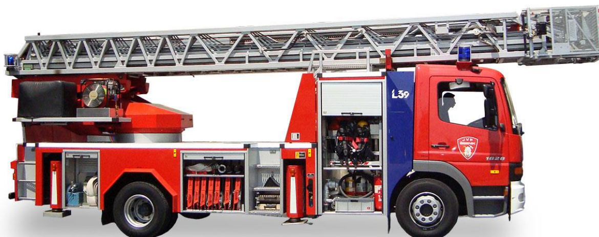
Slika 4. Vatrogasno vozilo za spašavanje sa visina [C]
