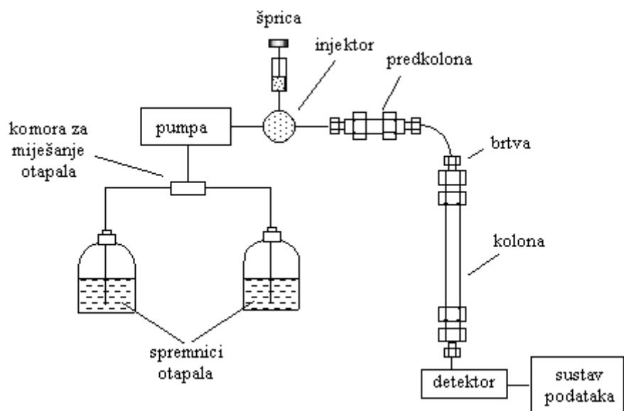
Slika 2. Shematski prikaz HPLC kromatografa (Luterotti, 2002)
