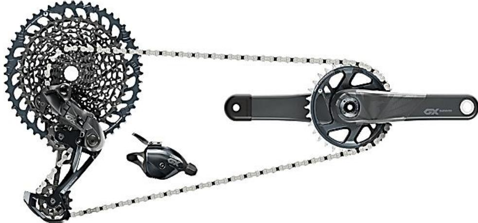
**Slika 47.** vanjski pogonski sklop bicikla
