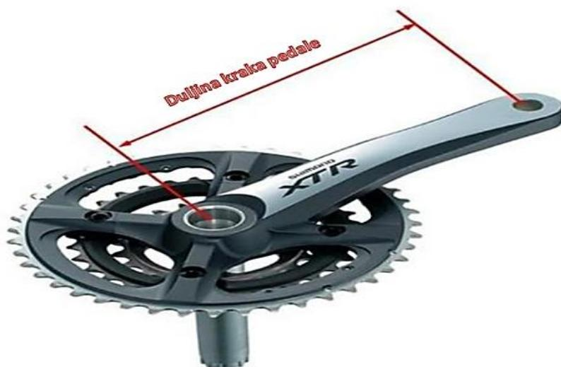
**Slika 37.** Mjerenje duljine ručice pedale
