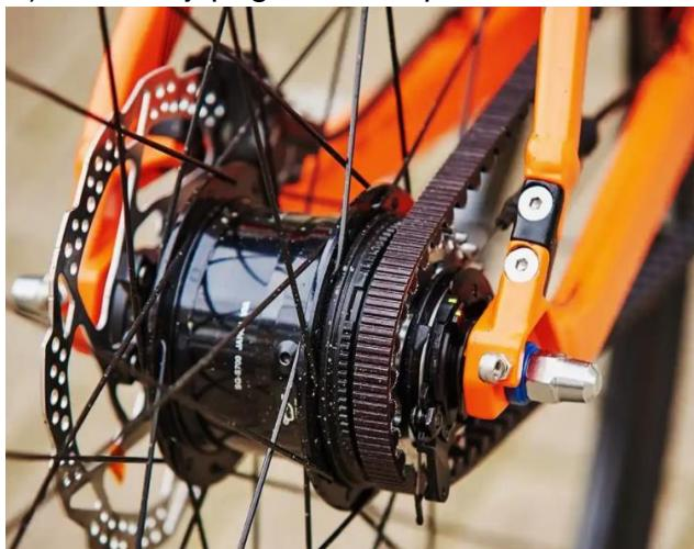
Slika 49. a) unutarnji prijenos brzina
