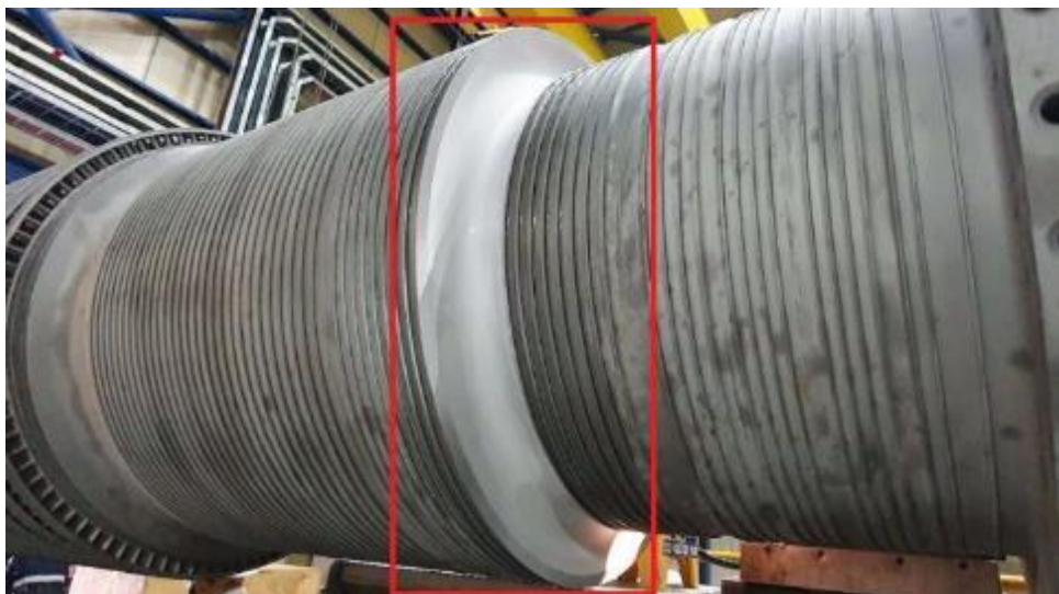
Slika 53. NDT nakon tokarenja konačne konture - bez indikacija
