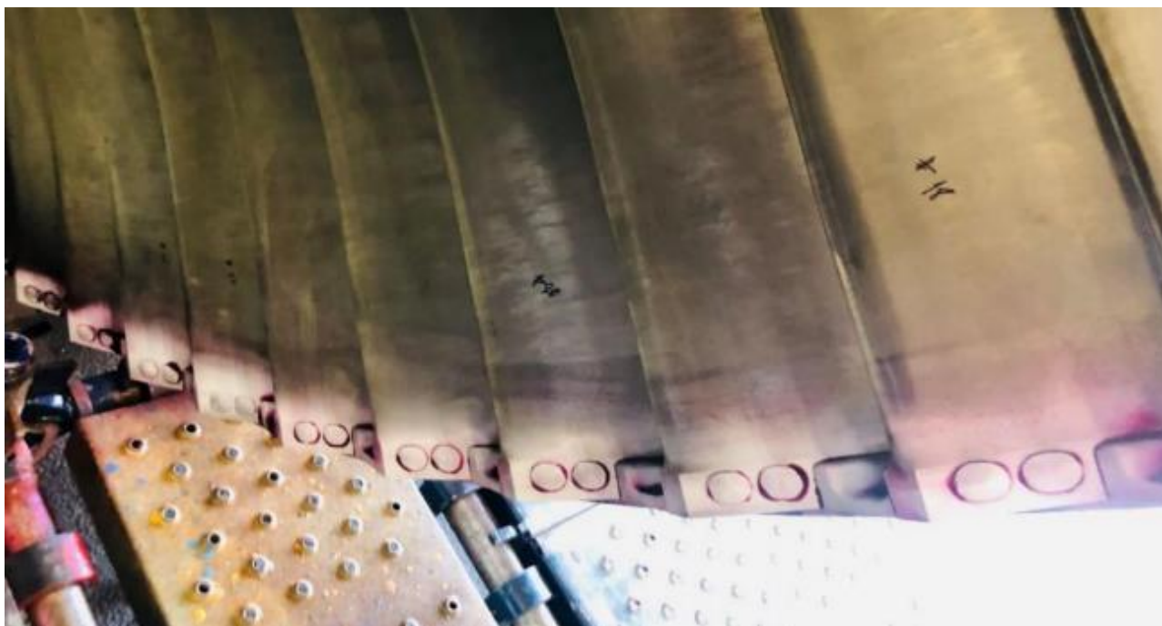
Slika 48. Završno ispitivanje penetrantima, bez indikacija
