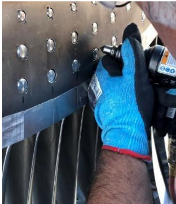
Slika 47. Osiguranje klinova od ispadanja
