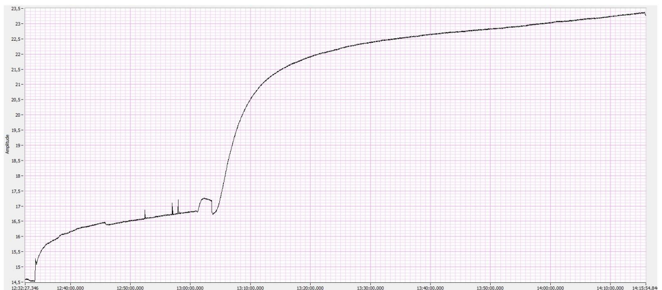
Slika 10. Grafički prikaz temperature, mjerno mjesto T2 (mehanička brtva) [9]
