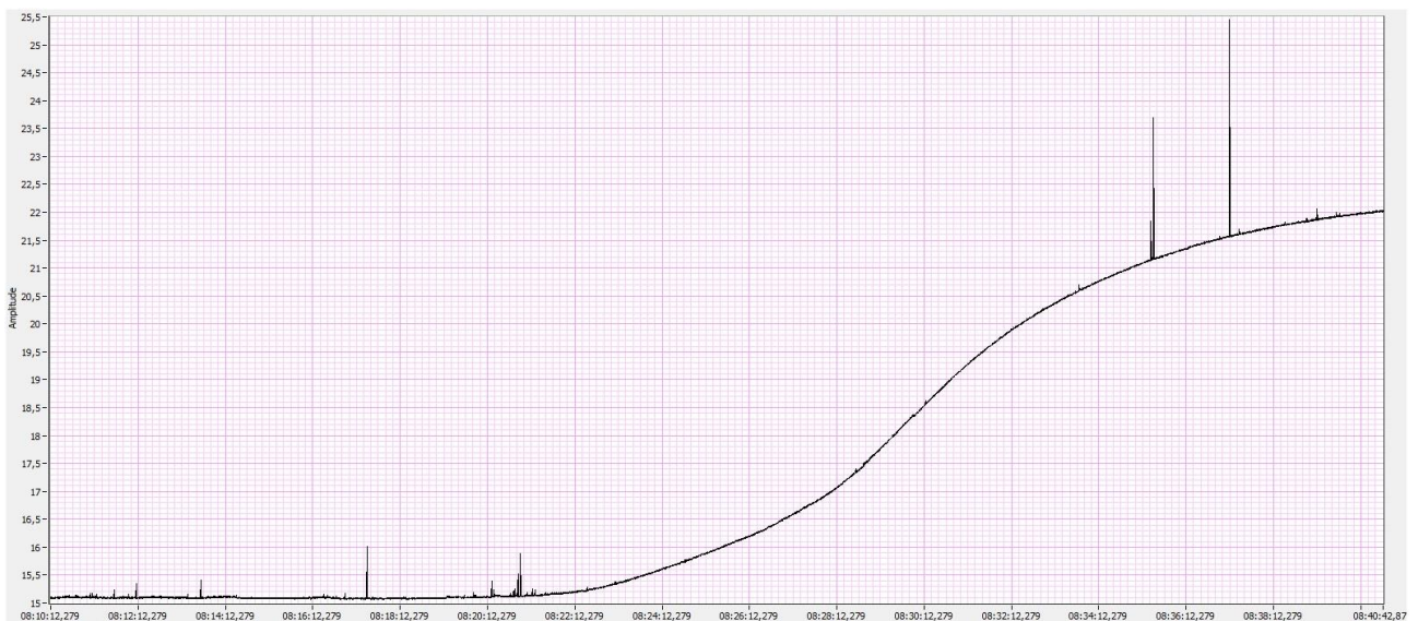
Slika 11. Grafički prikaz temperature, mjerno mjesto T1 – rad „na suho“ [9]
