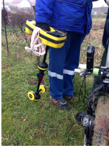
Slika 26. Lokator cjevovoda – proizvođača RIGID
