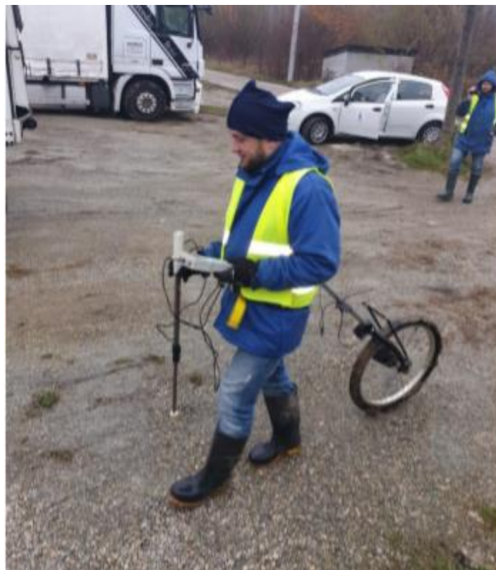
Slika 33. Magnetometrijsko snimanje VT plinovoda
