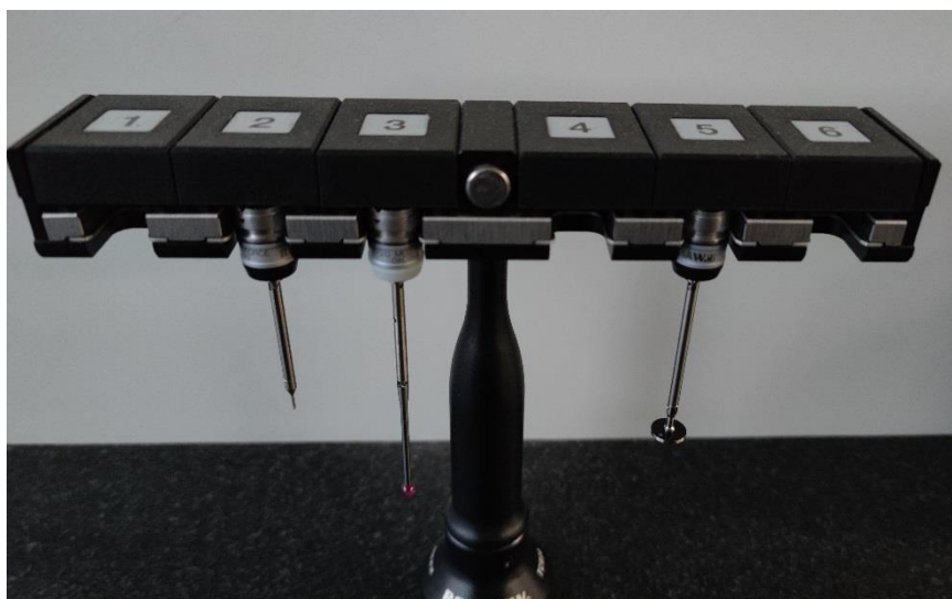
Slika 19. Stalac za ticala tvrtke OMP
