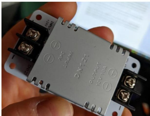
*Slika 38. Izgled „DN121“ DC-DC silaznog naponskog regulatora*
