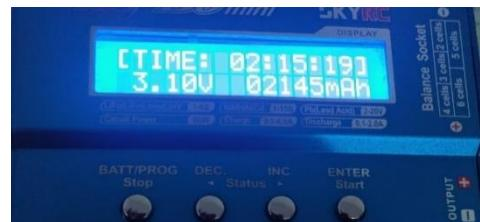
Slika 48. Vrijeme pražnjenja i vrijednost izmjerenoj kapaciteta prvog uzorka
