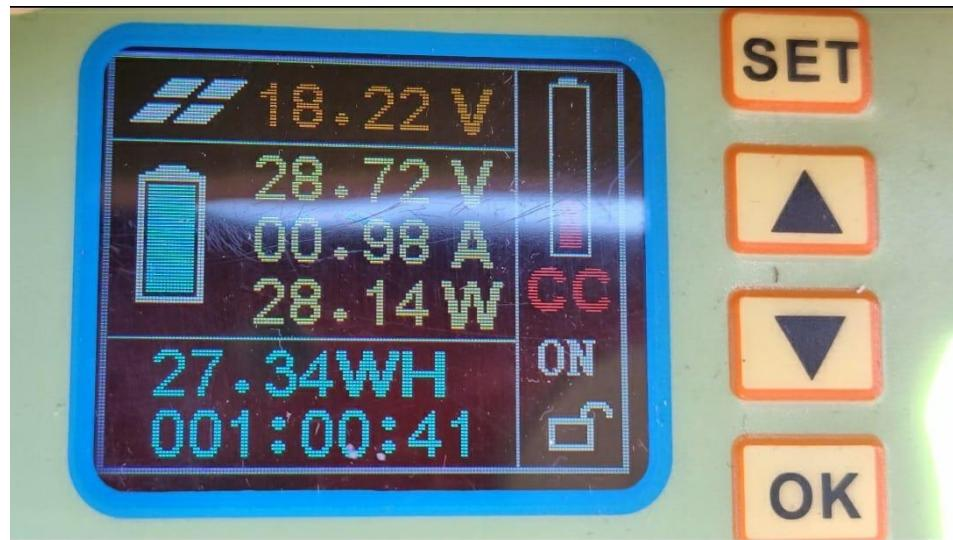
Slika 53. Vrijednosti solarnog punjenja na LCD-u kontrolera
