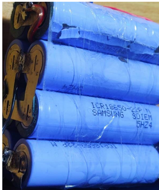
Slika 19. "ICR18650-22P" ćelija od koje je sačinjen baterijski modul
