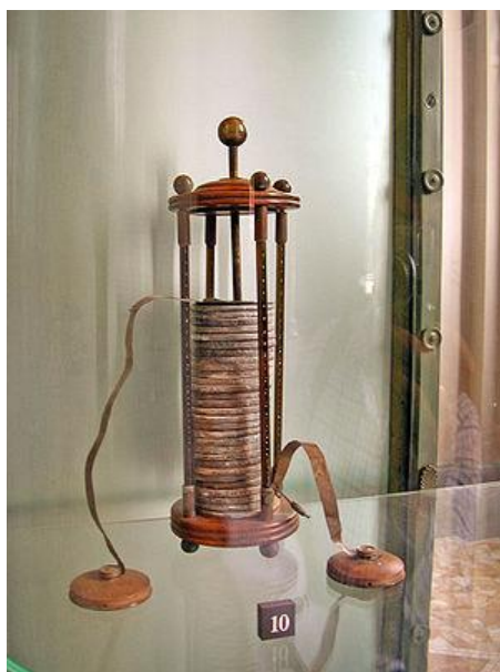
Slika 1. Voltin elektrostatički stup 1800. Godina [1]
