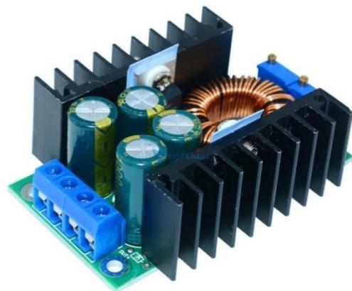
Slika 40. Izgled DC-DC silaznog prekidačkog naponskog regulatora [49]
