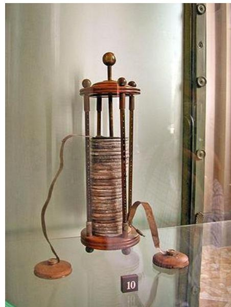
*Slika 1. Voltin elektrostatički stup
