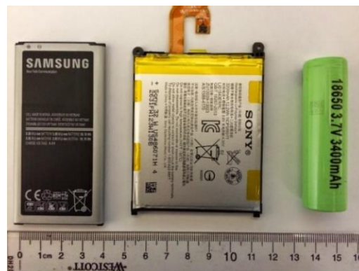
Slika 10. Dva najčešća fizička formata litij ion baterije
