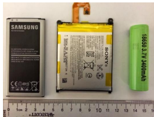
Slika 10. Dva najčešća fizička formata litij ion baterije
