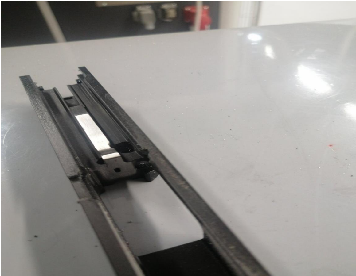
Slika 29. Prikaz izgleda zatvarača nakon procesa poliranja
