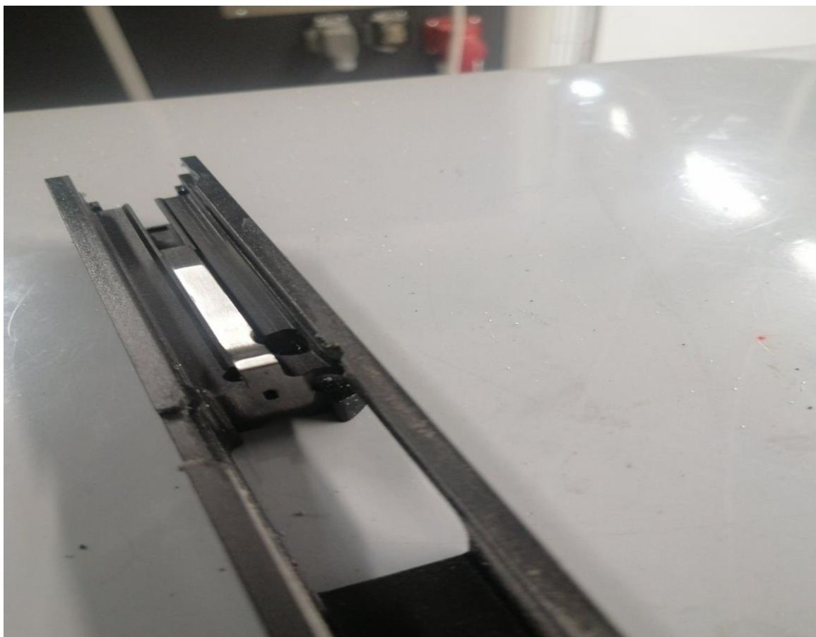
Slika 29. Prikaz izgleda zatvarača nakon procesa poliranja
