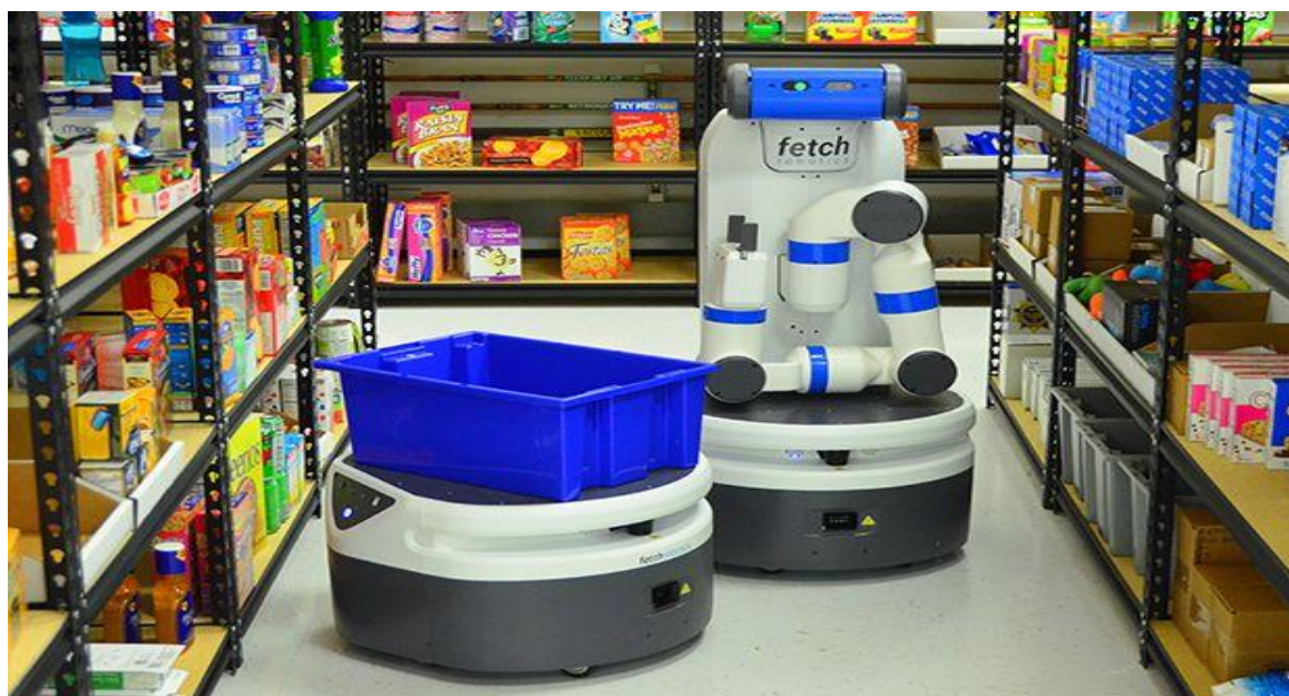
Slika 18. Prikaz robota za dohvaćanje i robota za prijevoz robe [36]
