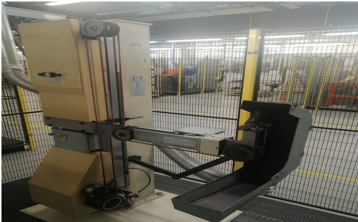
Slika 26. Vodilice za brusnu traku
