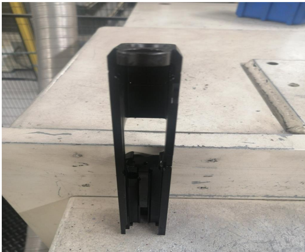
Slika 22. Izgled obratka (zatvarača) prije poliranja
