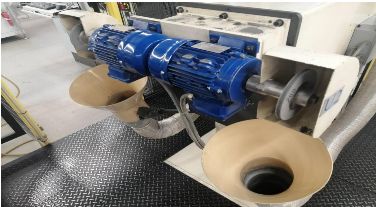
Slika 24. Dva brusna kotača s ventilacijom
