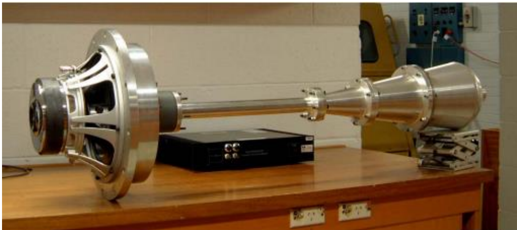
Slika 27. Termoakustički hladnjak (TAR) [10]
