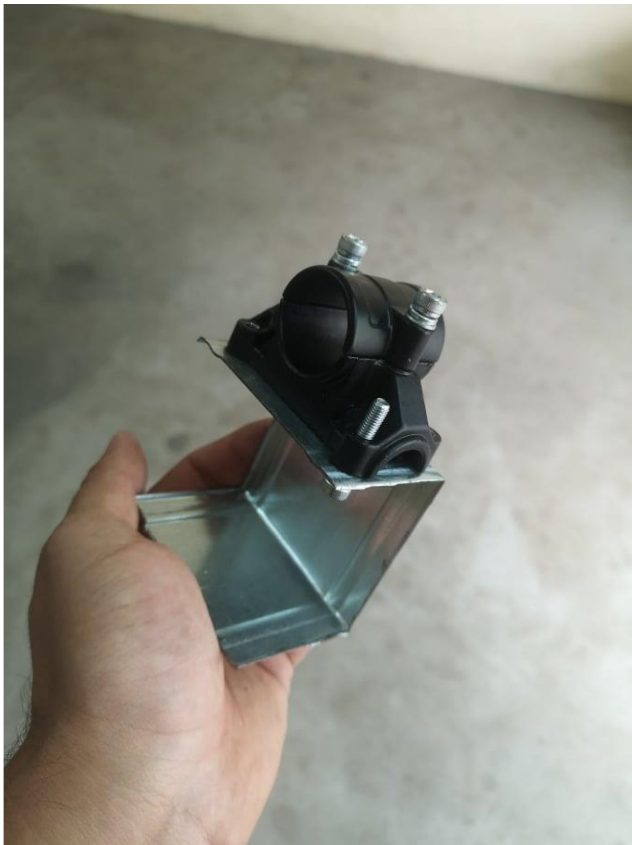
Slika 32. Spoj prvog i drugog dijela nosača
