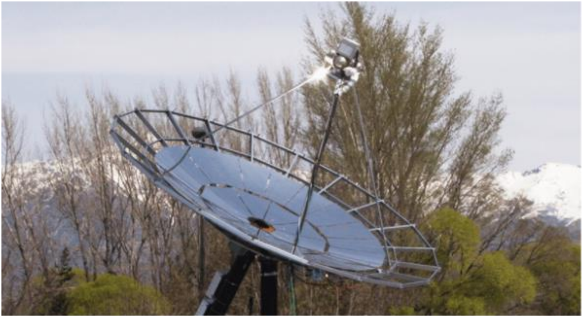
Slika 28. Solarni termoakustički stroj [12]
