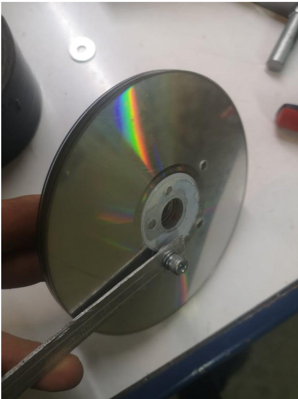
Slika 42. Spoj klipnjače sa radnim kolom
