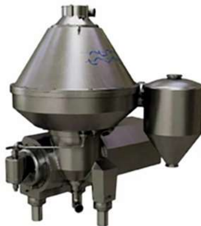
Slika 7. Baktofuga za mlijeko Alfa Laval BB520 (Alfa Laval, 2021).
