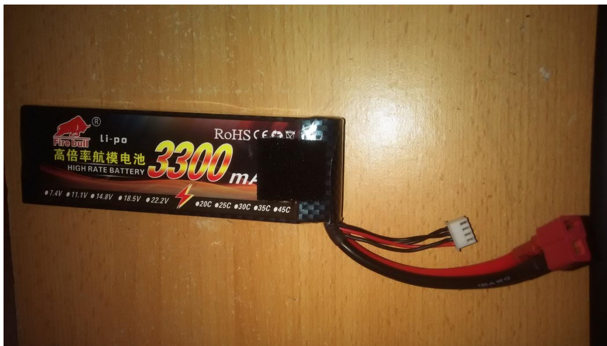
Slika 16. Fire Bull 3S 3300 mAh 25C baterija
