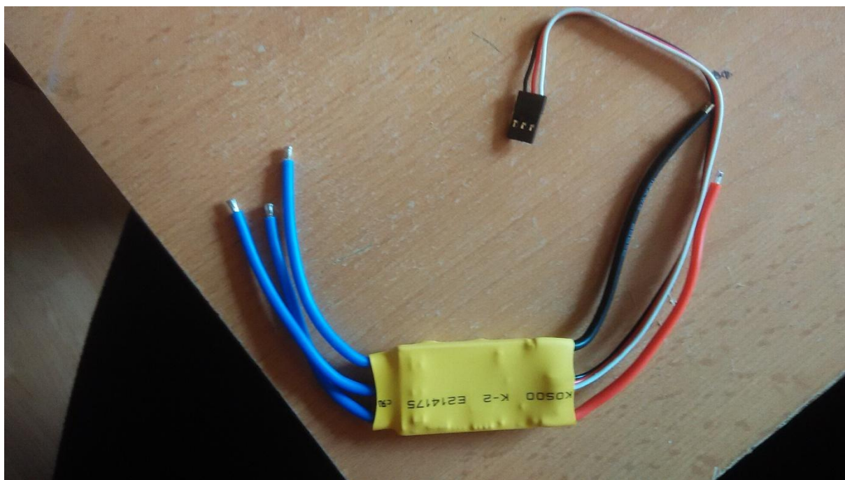
Slika 15. Elektronički komutator s integriranim eliminatorom baterijskog kruga
