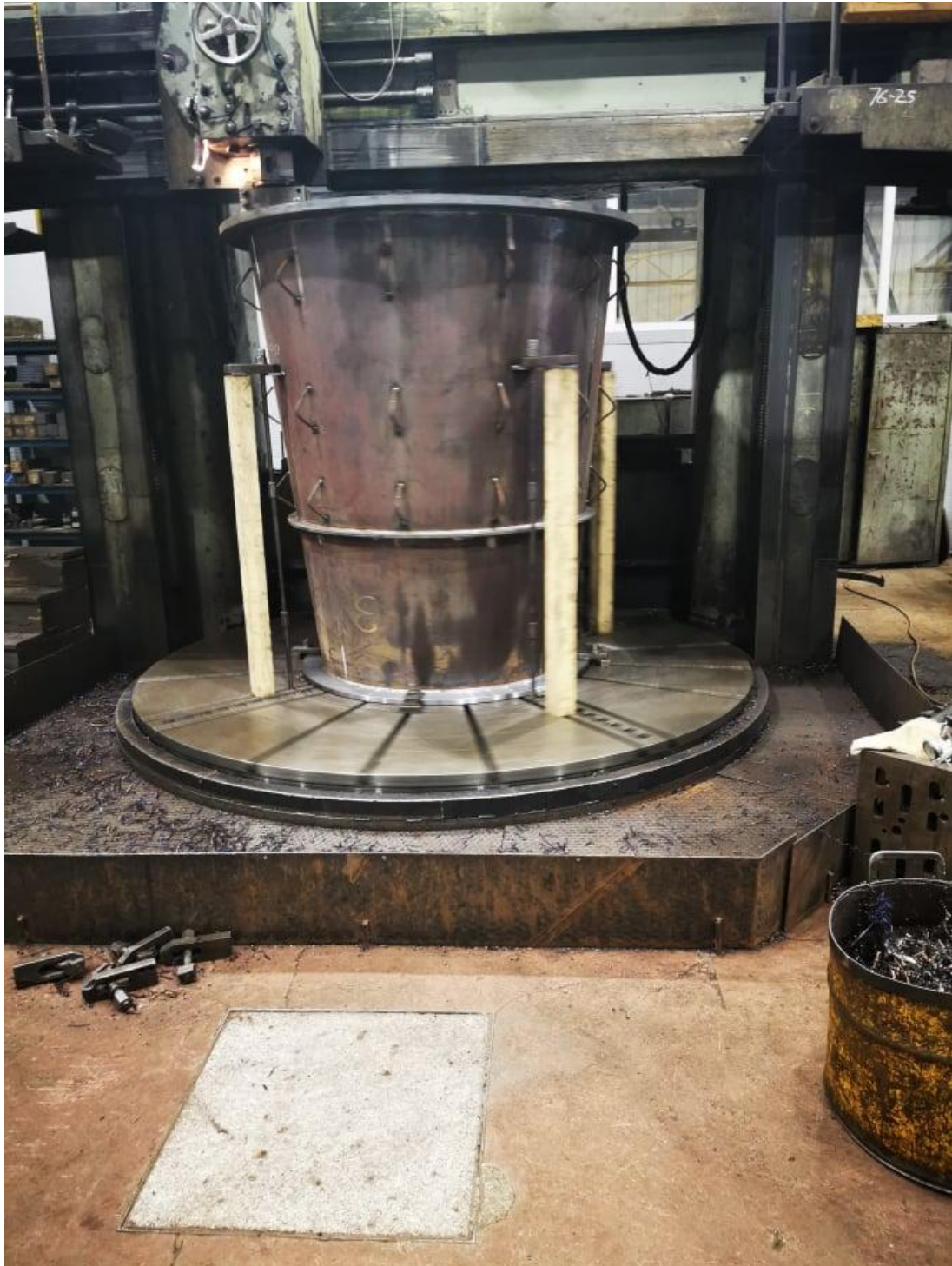
Slika 5.4 Vertikalna tokarilica RAFAMET KCF-320.
