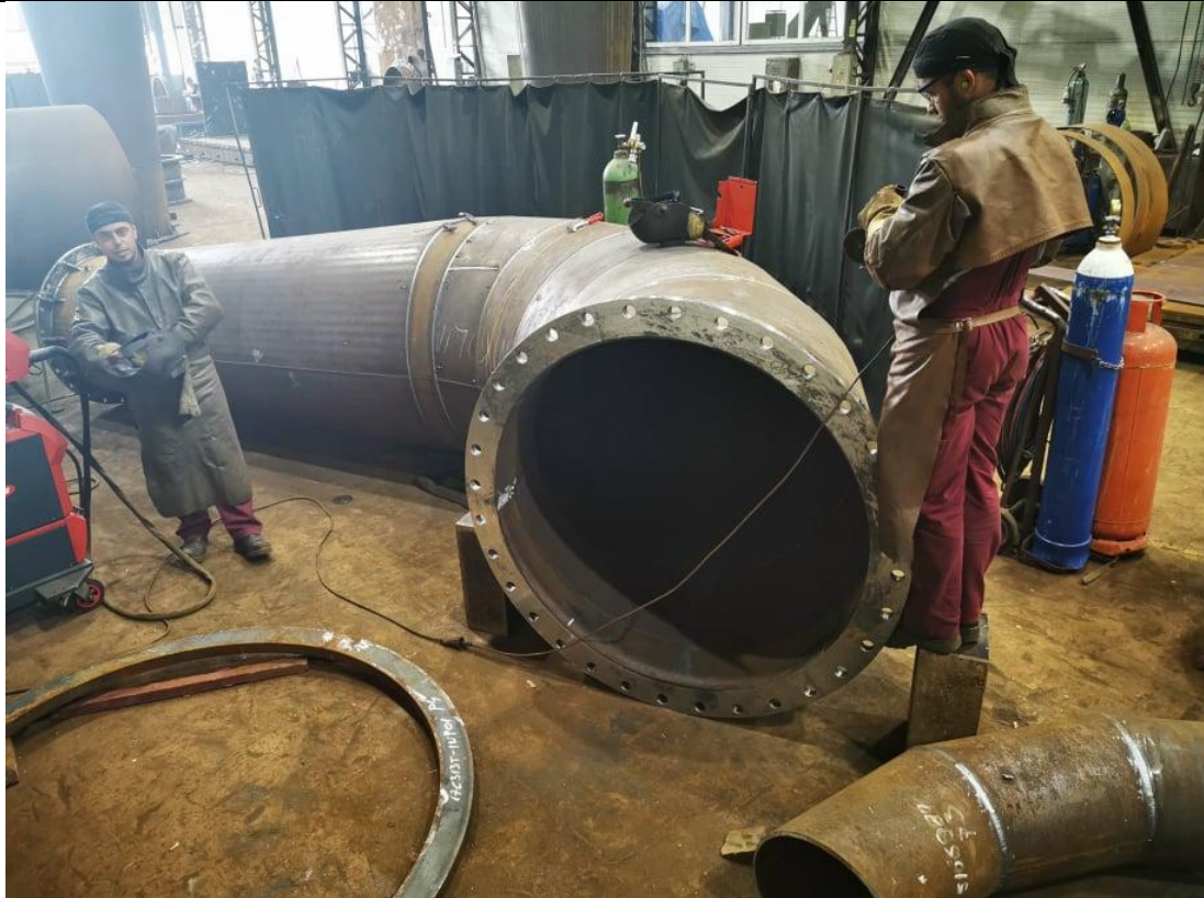
Slika 14.3 Kompletno bravarski složena pozicija na zavarivanju.
