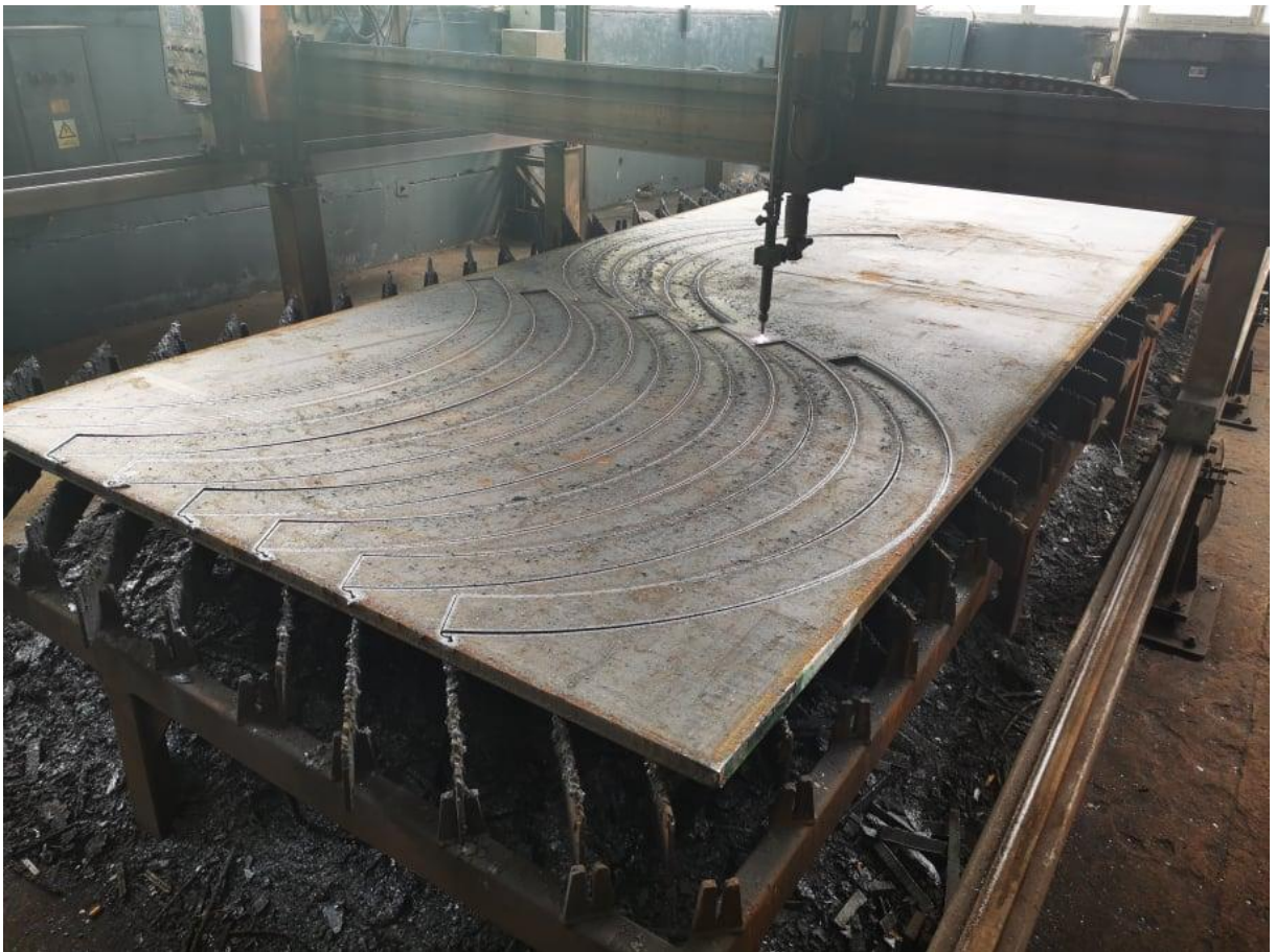
Slika 5.1 CNC plinska rezalica Varstroj.
