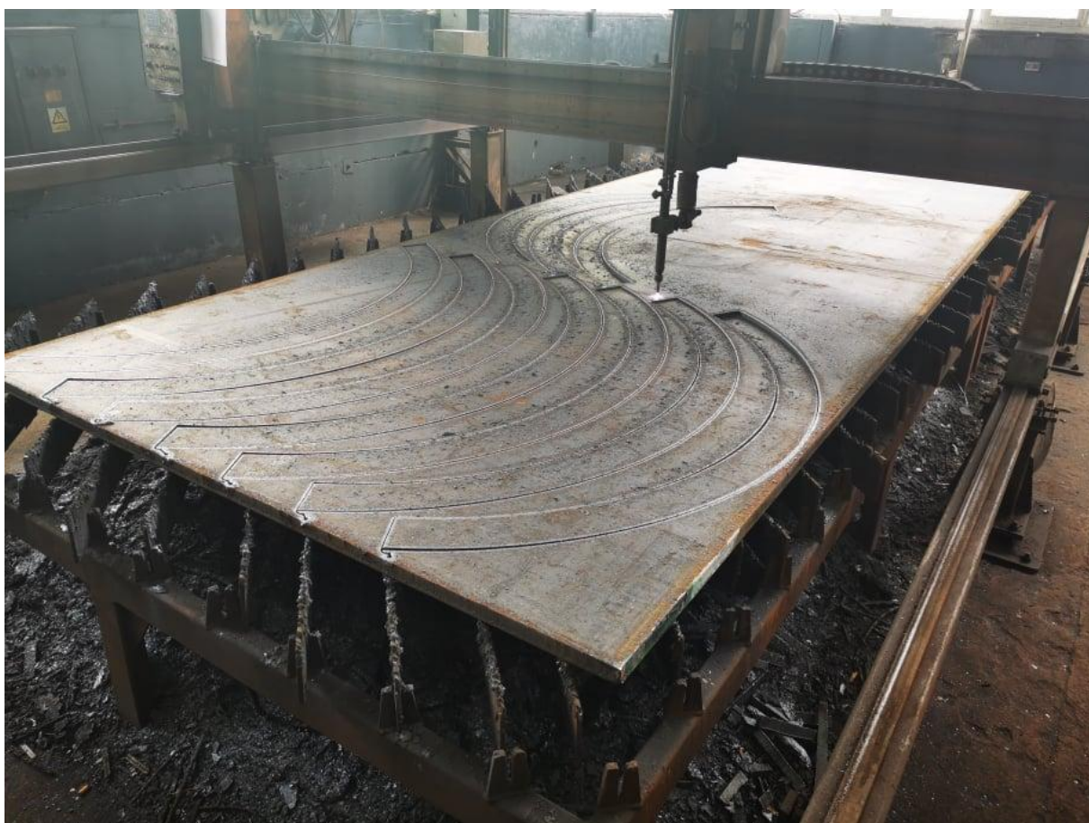
Slika 5.1 CNC plinska rezalica Varstroj.
