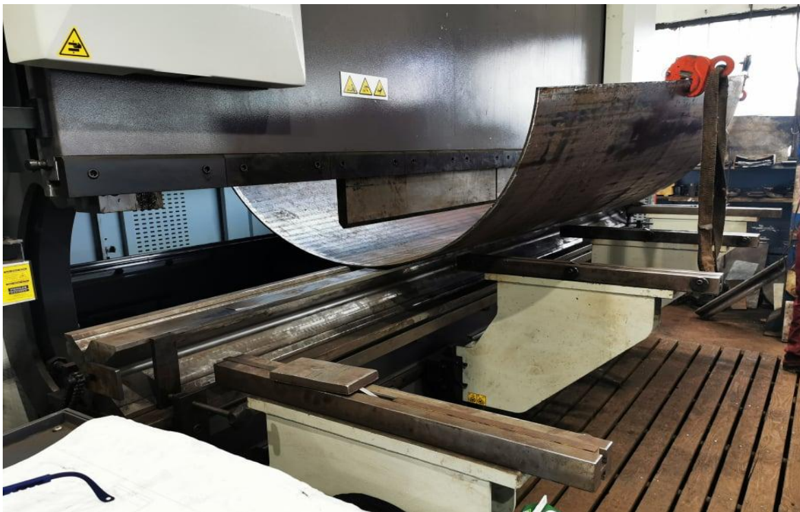
Slika 10.2 Ocrtane linije savijanja p.9/4.
