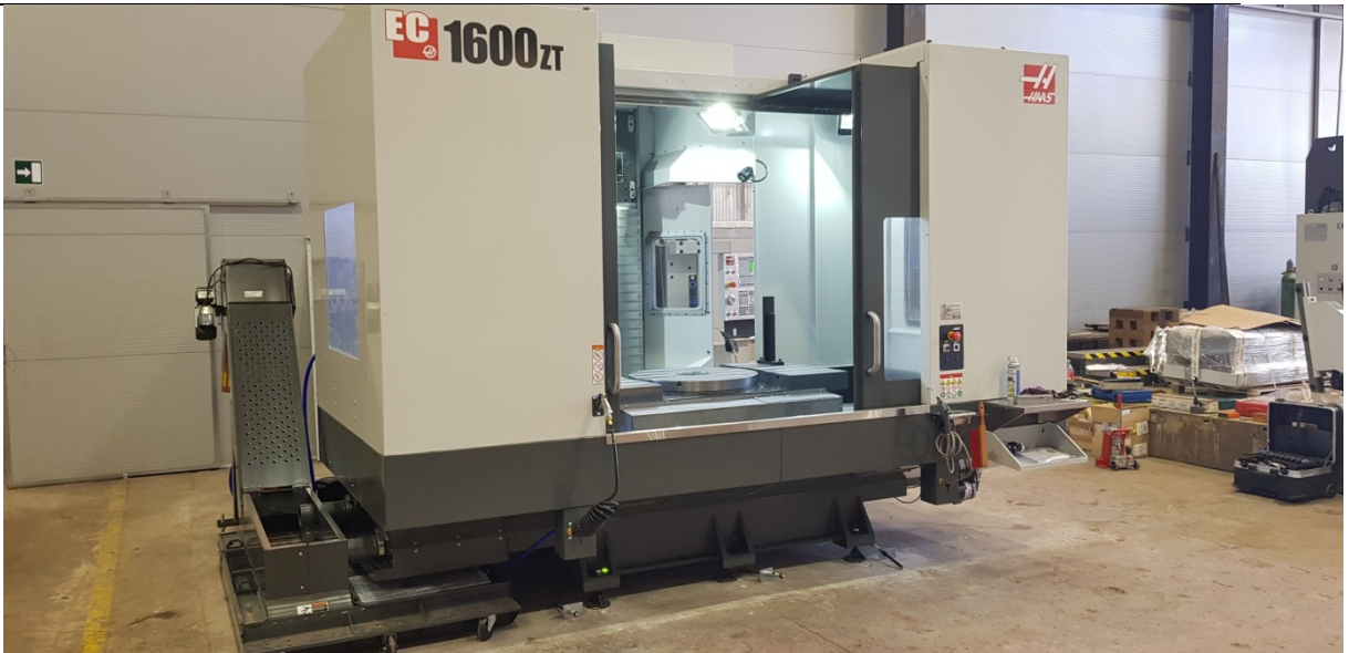
Slika 5.6 Horizontalni obradni centar HAAS EC 1600 ZT.
