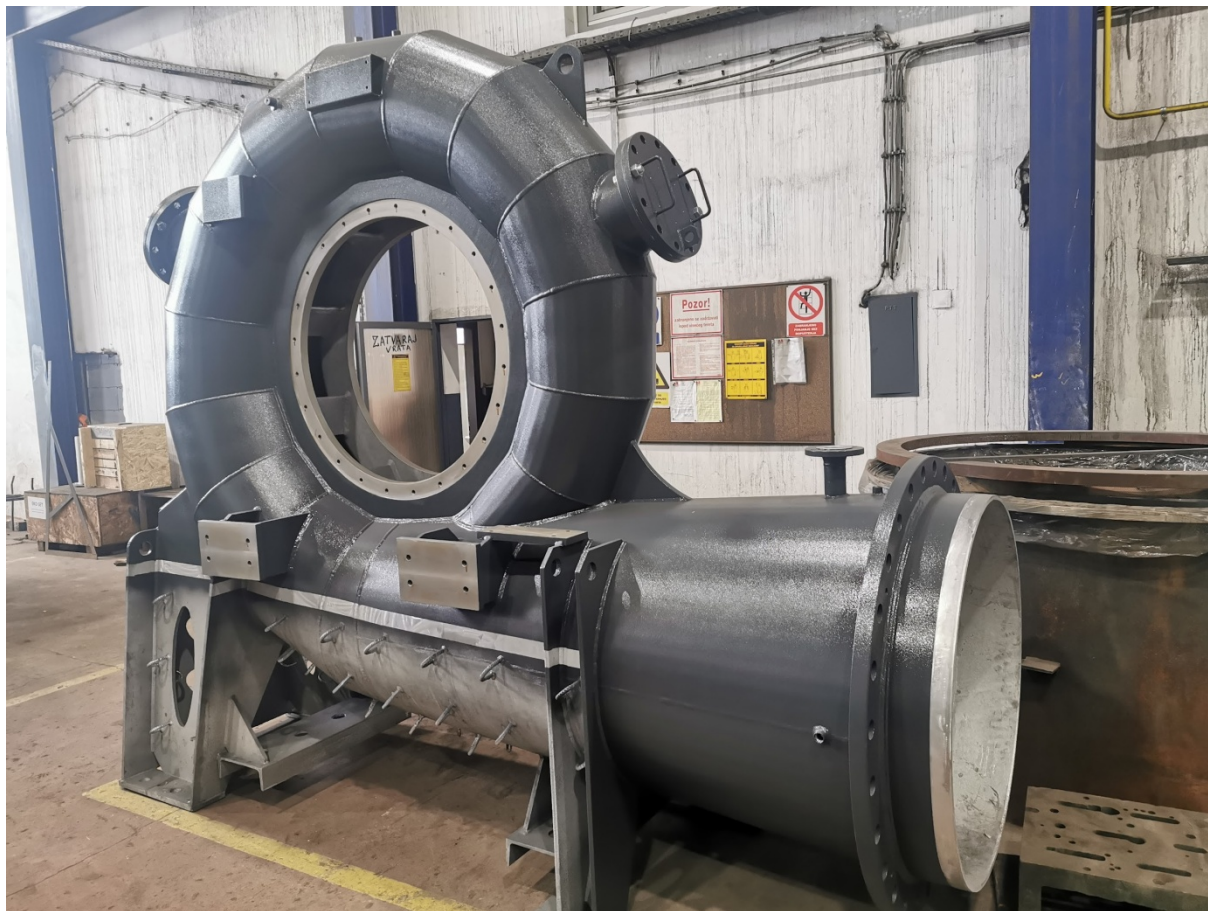
Slika 2.3.3 Spiravno kućište francis turbine proizvedeno u AB Produktu.
