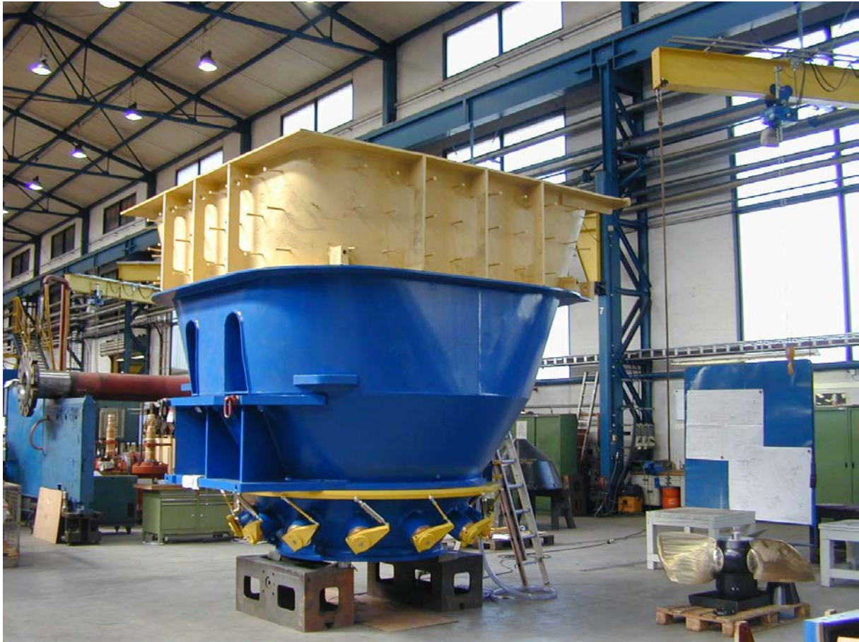
Slika 2.3.4 Kućište kaplan turbine proizvedeno u AB Produktu.
